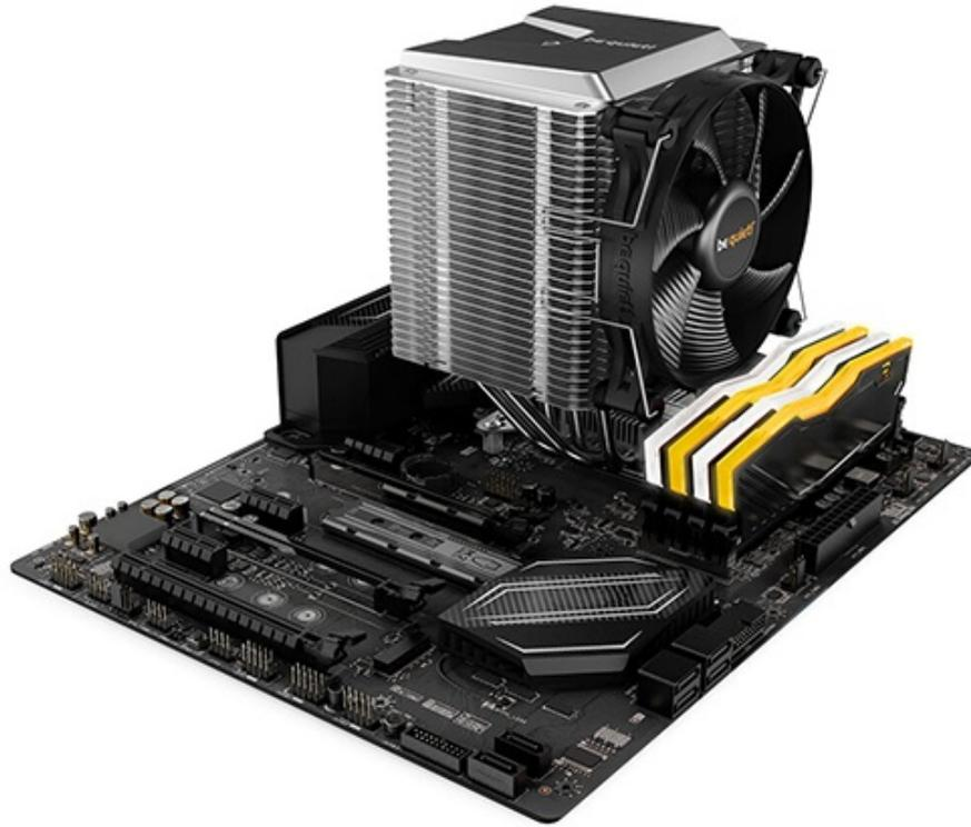
Il dissipatore, inoltre, è leggermente decentrato rispetto al socket al fine di assicurare la compatibilità con moduli RAM ad alto profilo.
