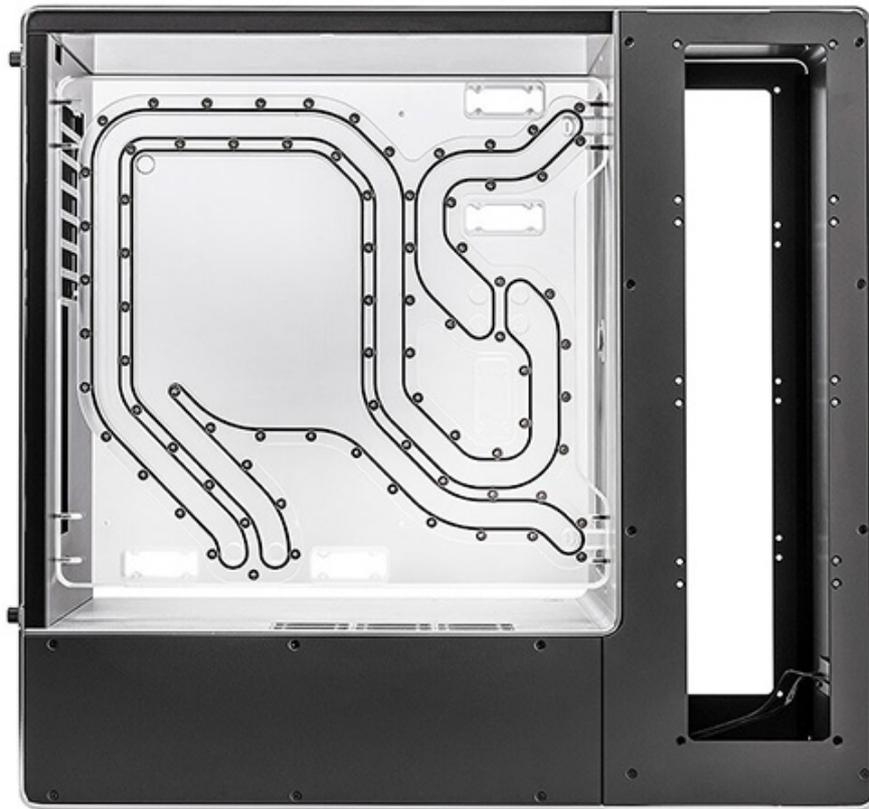
L'EK-Quantum In Win 909EK - Silver Limited Edition è una versione pesantemente modificata dell'iconico 909 di In Win, con una piastra mainboard realizzata in acrilico che funge da piastra di distribuzione per sistemi di raffreddamento a liquido custom.
