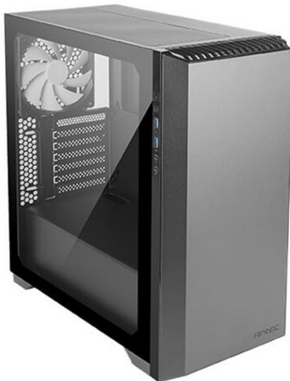
Oltre ad una scheda madre in formato ATX o inferiore, potranno trovar spazio schede video lunghe 380mm, dissipatori ad aria per CPU alti 178mm e, all'interno di appositi scomparti che risulteranno nascosti guardando il case attraverso il vetro temperato, un alimentatore ATX da 220mm più due drive da 3,5" e due da 2,5".
