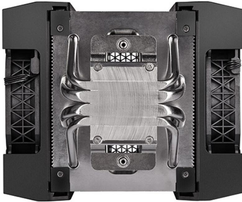
Tale dissipatore, raffreddato attivamente da due ML120 PWM a levitazione magnetica e sistema di fissaggio "slide and lock", è composto da un mastodontico corpo lamellare con quattro heatpipes per lato che, una volta montato, saranno a diretto contatto con la CPU.
