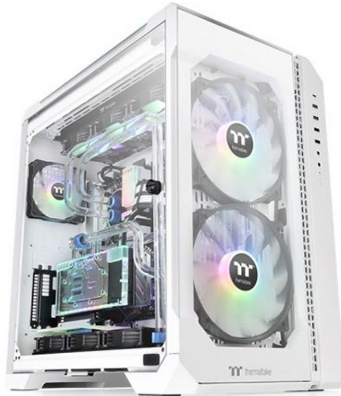
Frontalmente sono preinstallate due ventole da 200mm con sistema di illuminazione ARGB, che potranno essere sostituite da tre da 120 o 140mm.
