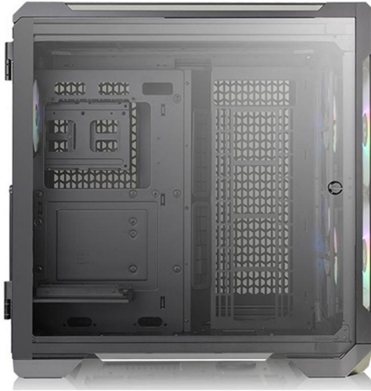
Nello scomparto di sinistra è possibile installare una scheda madre in formato ATX o inferiore, schede video lunghe 440mm e dissipatori ad aria alti 175mm.
