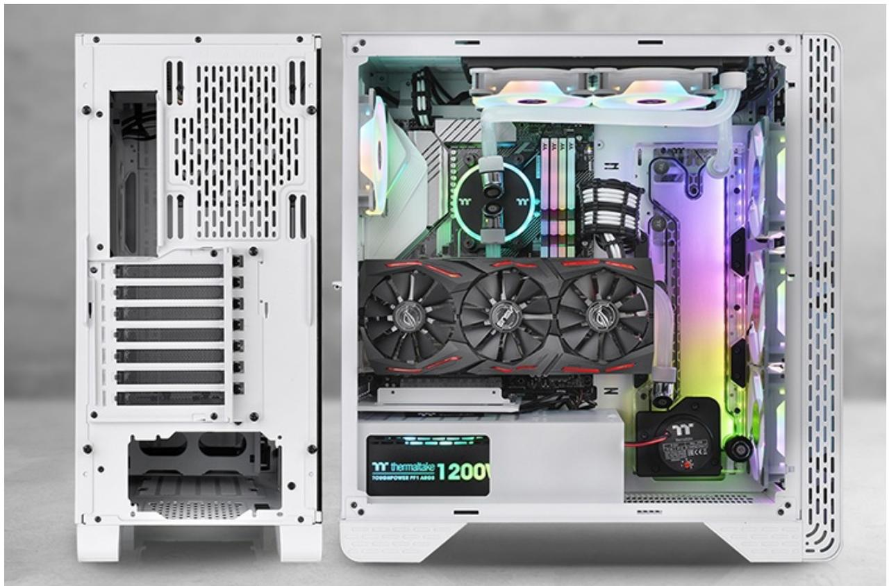
Tutto ciò si traduce in una elevata versatilità per i sistemi di raffreddamento a liquido che potranno essere composti da un radiatore da 360mm o 280mm sul frontale, uno da 280 o 240mm sul top e, qualora non fossero necessari i due cestelli per drive da 3,5", un'altro da 360mm posizionato a destra del piatto mainboard.
