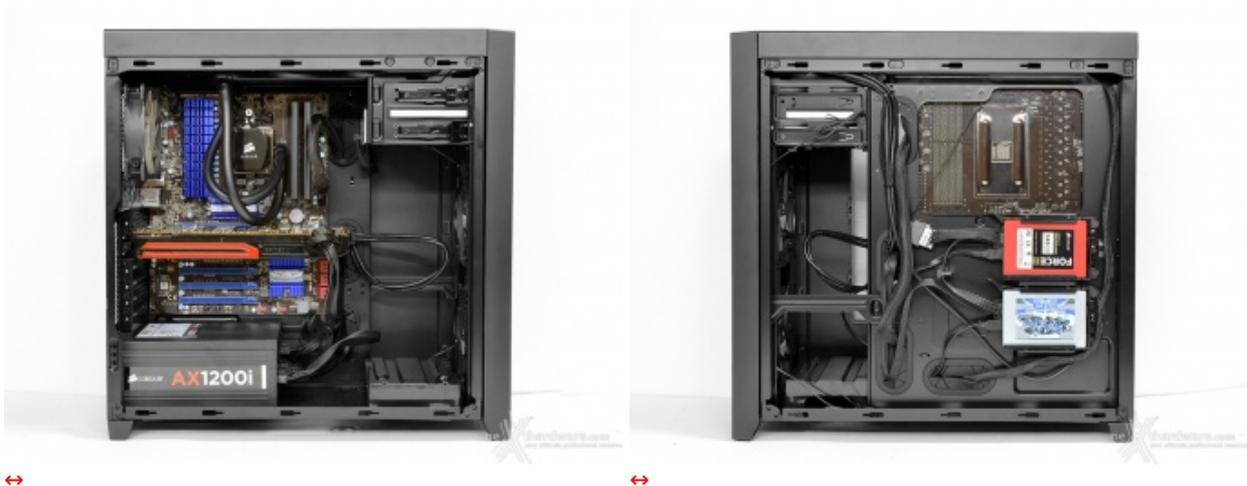
Nella fase finale è stata installata la scheda video AMD HD 7970 ed è stato completato il cablaggio, inserendo i connettori per l'alimentazione ed i cavi rimanenti.
