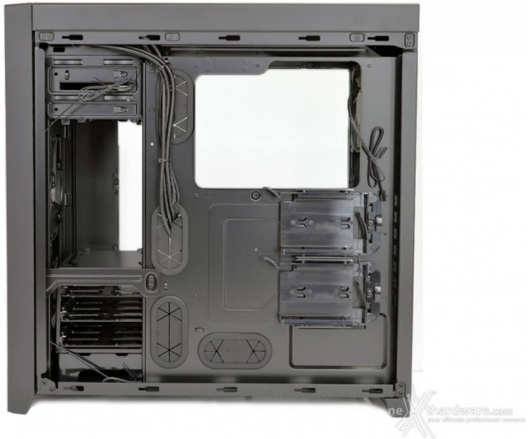
Sul vassoio, in corrispondenza del socket CPU, troviamo, come di consueto, un ampio scasso che ci permetterà di effettuare le operazioni di manutenzione senza dover rimuovere preventivamente la motherboard.
