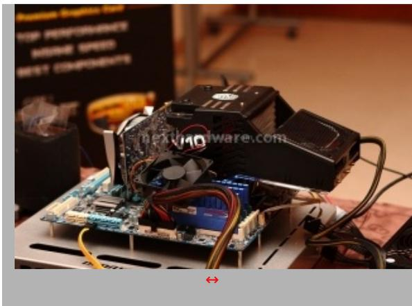
La totalità dei concorrenti ha installato per i test preliminari, cooler ad aria per verificare che il sistema funzionasse a dovere.
