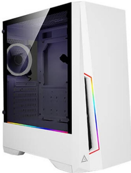
Tutte le predisposizioni potranno essere affiancate da radiatori facenti parte di sistemi di raffreddamento a liquido custom; i più esperti avranno quindi la possibilità di assemblare un sistema dual loop con un radiatore da 280mm sul top e uno da 360mm frontalmente.
