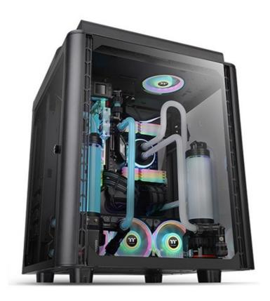
Per quanto concerne i sistemi di raffreddamento a liquido, sarà possibile utilizzare due radiatori da 360mm con l'open space dello scompartimento frontale che consentirà il posizionamento di vaschette tubolari di generose dimensioni.
