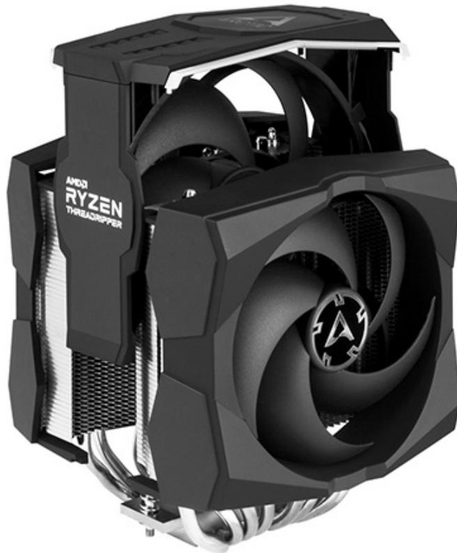
Il nuovo Freezer 50 TR, infatti, è un dissipatore a doppia torre, alto 165mm, raffreddato attivamente da due ventole ARCTIC-P di cui una da 120mm montata su di un lato ed una da 140mm posta tra i due corpi lamellari.
