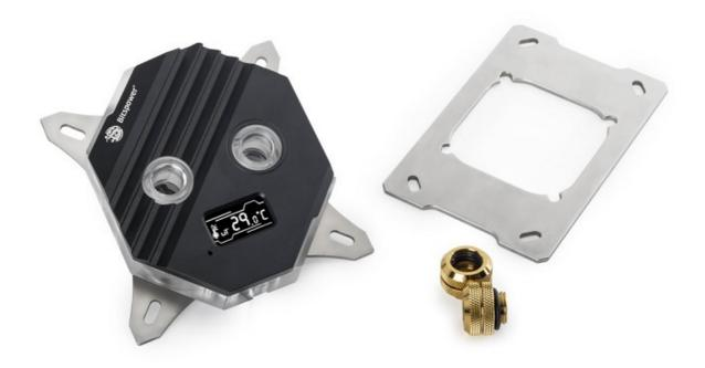
Il cuore del nuovo Summit M risiede nella superficie di contatto con base in rame che, tramite un corpo lamellare a superficie maggiorata con alette da 0.3mm e acceleratore di flusso centrale, garantisce elevate prestazioni termiche.
