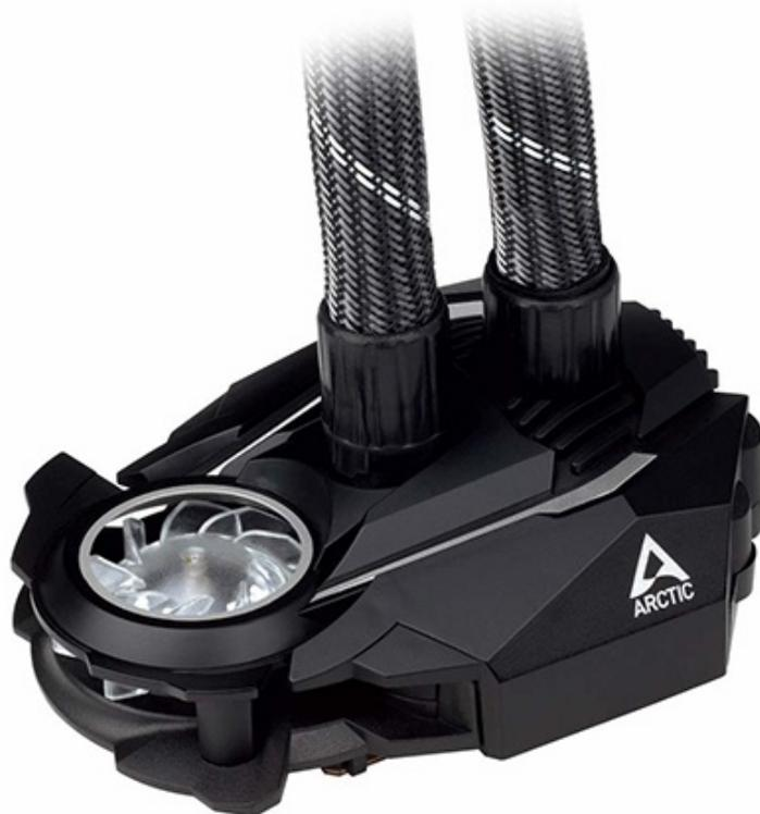
Grazie alle ridotte dimensioni di quest'ultima, il waterblock con base in rame risulta alquanto insolito data l'integrazione una ventolina da 40mm dedicata, in particolar modo, al raffreddamento delle fasi d'alimentazione che circondano la zona socket.
