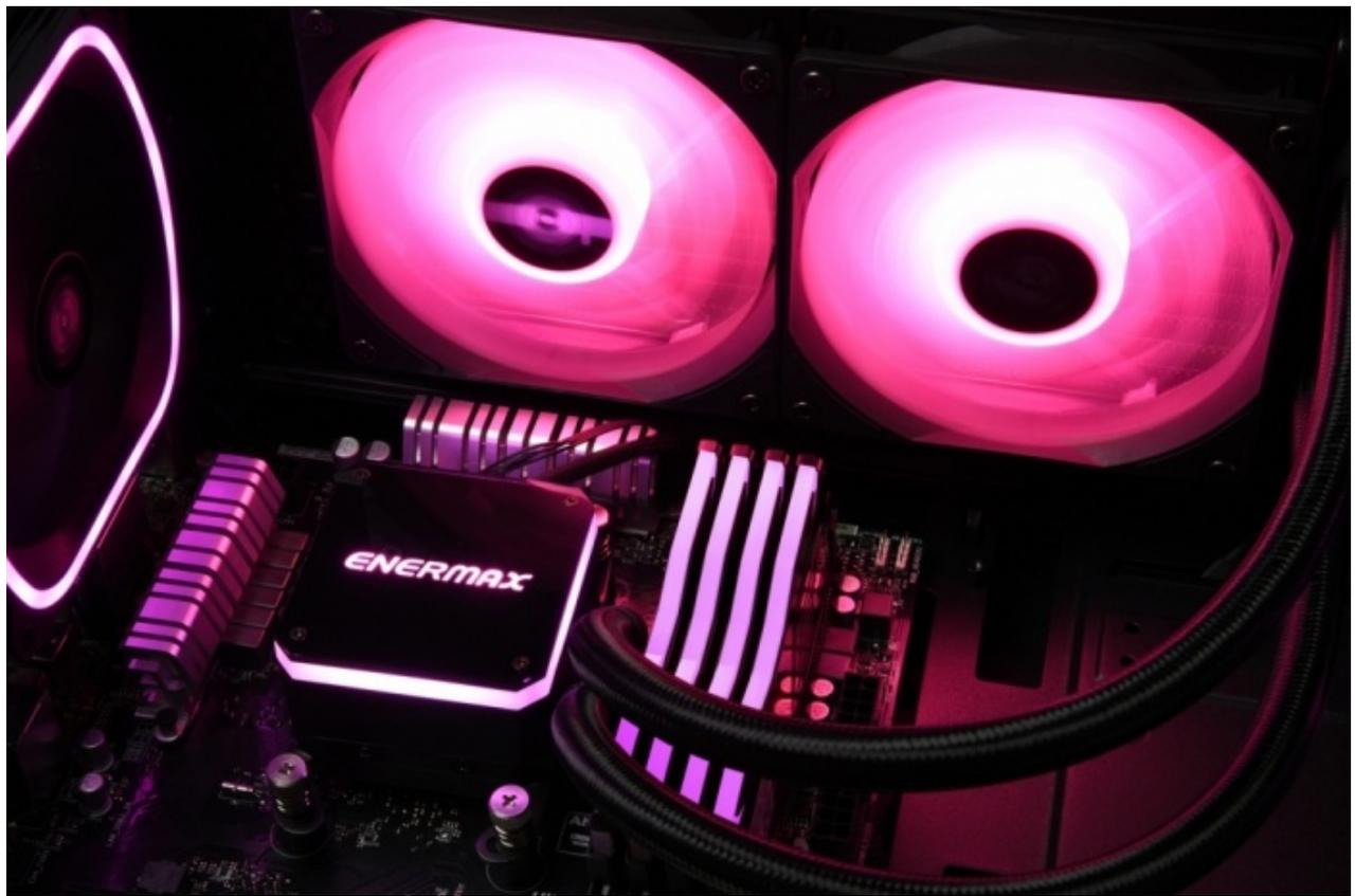
La struttura centrale del waterblock (CCI) è studiata per indirizzare il flusso del liquido refrigerante nel punto più caldo riducendone il percorso così da ottenere un trasferimento di calore più veloce e migliori prestazioni di raffreddamento
