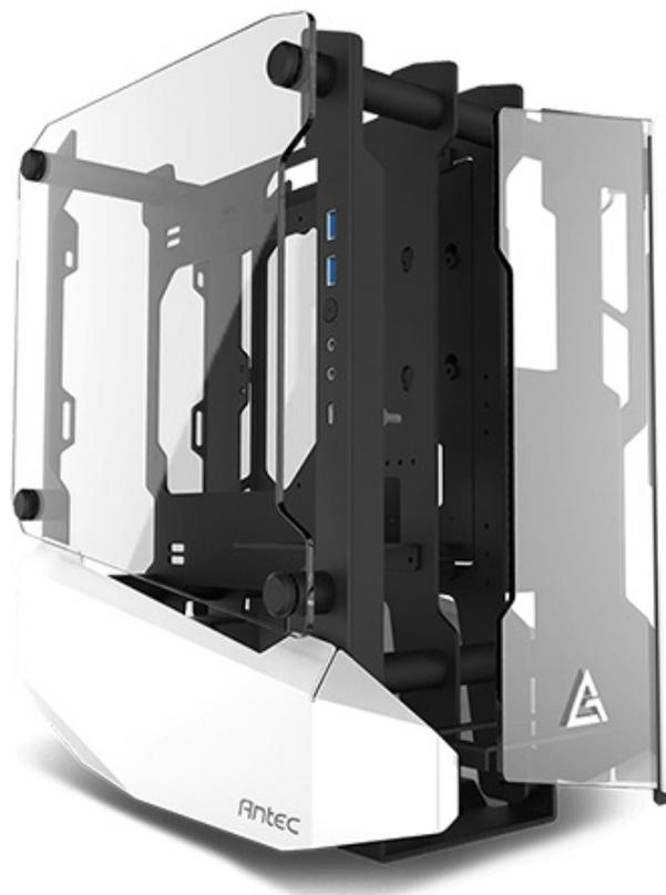
Per restare al passo con i tempi, il pannello I/O, posizionato nella parte frontale sinistra, comprende due jack HD Audio, il pulsante di accensione, due USB 3.0 ed una USB type C.
