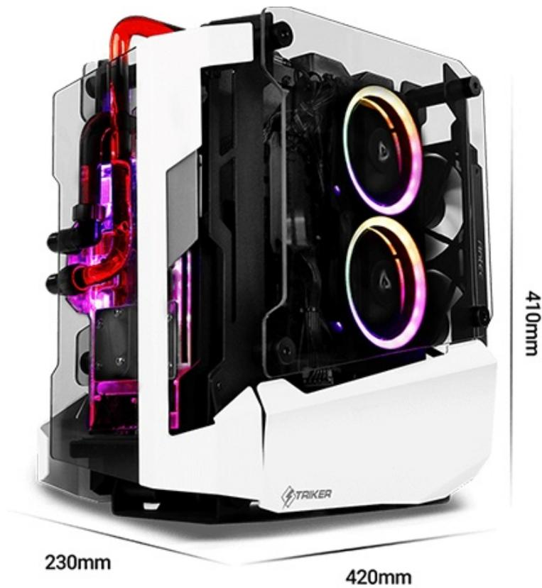
Nonostante le dimensioni di 410x420x230mm (AxPxL), l'accattivante Mini Tower è in grado di contenere, all'interno di una robusta struttura in alluminio lavorata con macchine a controllo numerico e paratie in vetro temperato spesse 4mm, una scheda madre in formato ITX ruotata di 90° in senso antiorario ed una scheda video lunga fino a 330mm che andrà posizionata, grazie all'ausilio di un Riser Cable incluso, sul frontale.
