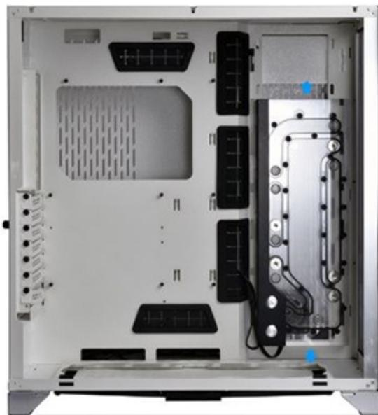
All'interno dei case O11D e O11D XL, la Distro Plate andrà piazzata a destra del vano mainboard, in corrispondenza della predisposizione per le tre ventole da 120mm.
