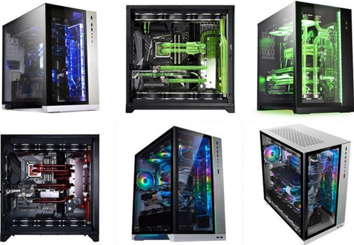
Sfruttando i fori per raccordi con passo G1/4, sarà possibile collegare, preferibilmente tramite tubi rigidi, un waterblock per CPU, due per schede video e due radiatori da 360mm con spessore massimo da 60mm.
