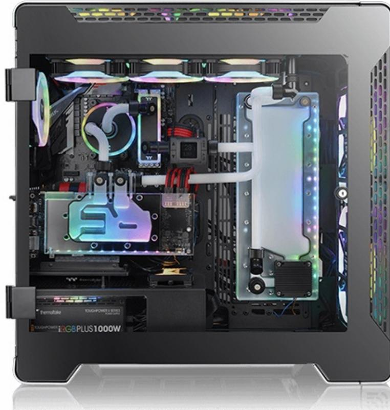
Tutte le predisposizioni potranno essere affiancate da radiatori facenti parte di sistemi di raffreddamento a liquido; a destra del piatto mainboard, inoltre, rimuovendo i cestelli per i drive, potrà essere installato un ulteriore radiatore da 360 o 420mm oppure, come mostra l'immagine, una vaschetta custom.
