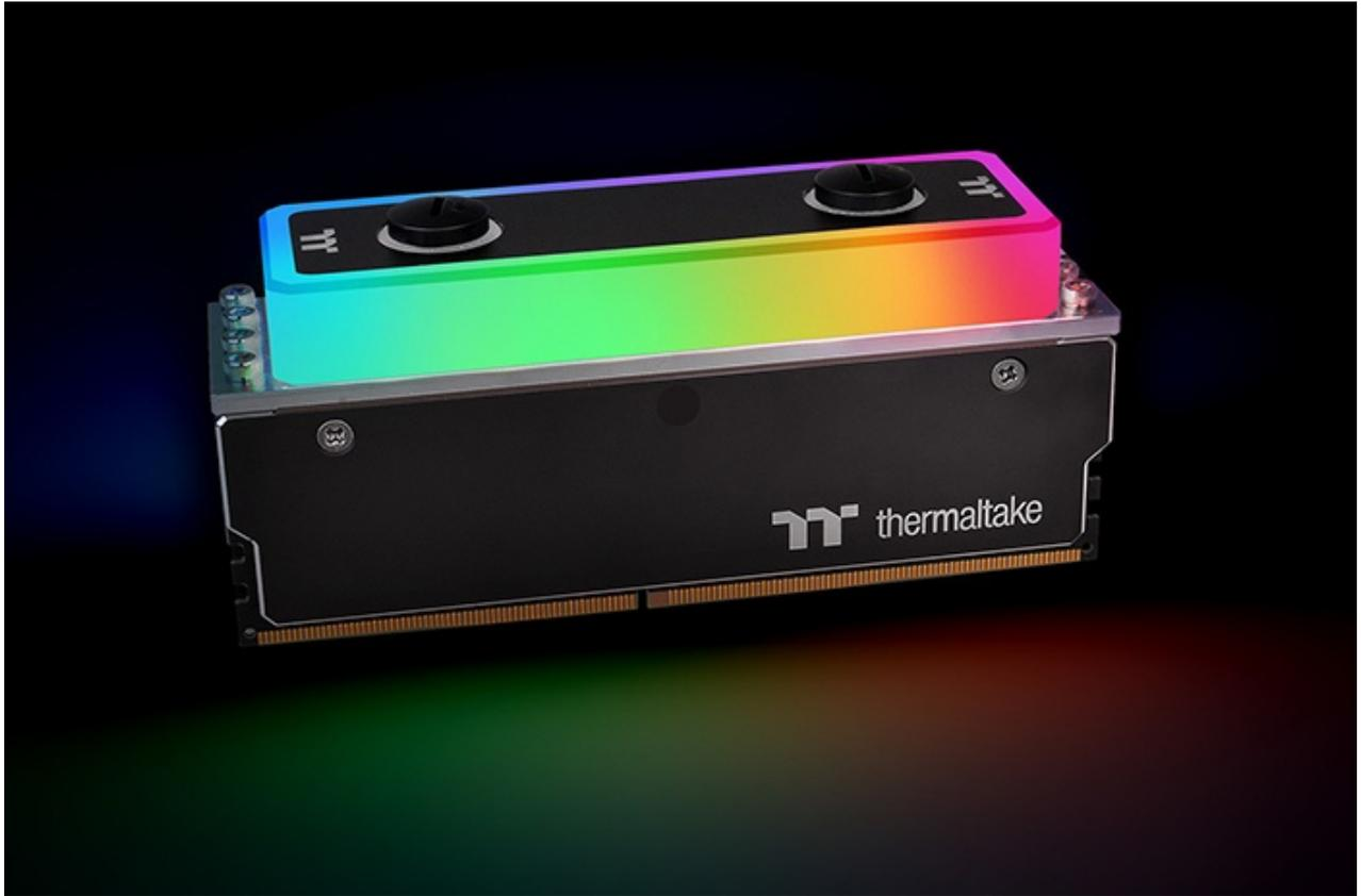
Il waterblock in acrilico con base in rame va installato direttamente nella parte alta dei dissipatori in alluminio dei moduli RAM e, volendo, potrà essere usato anche senza essere collegato ad un circuito di raffreddamento a liquido, come un semplice accessorio.
