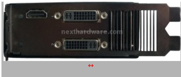
DVI è infatti saldato al secondo PCB della scheda. Sono presenti anche due led. Il primo, di colore blu, indica in un sistema QuadSLI, quale scheda è abilitata all'output; il secondo, verde/rosso, indica la corretta o l'erronea installazione dei cavi di alimentazione.
