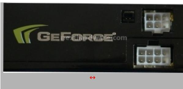
I connettori di alimentazione sono originariamente coperti da un adesivo al fine di richiamare l'attenzione dell'utente al collegamento dei cavi aggiuntivi. Per il corretto funzionamento della scheda è necessario collegare un cavo PCI-E 6 pin e un cavo PCI-E 8 pin. Nella stessa area è presente una connessione 2 pin per il cavo SDPIF, necessario per veicolare l'audio al connettore HDMI integrato.
