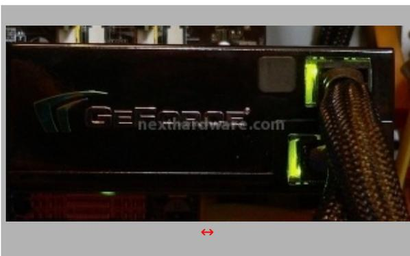
In caso di errata installazione dei cavi di alimentazione, i connettori cambiano colore segnalando l'anomalia. Questo piccolo dettaglio aumenta ancor più il valore della scheda, nVidia ha curato tutti i particolari, anche estetici, del prodotto.
