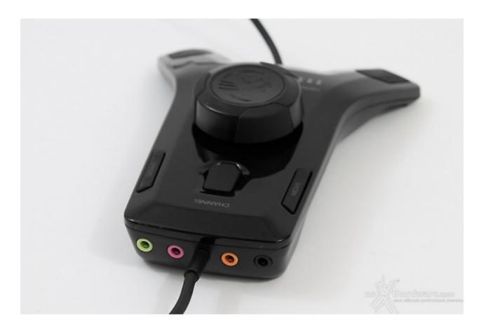
Quattro uscite analogiche, per un totale di 5.1 canali, sono disponibili per collegare un eventuale sistema di speakers, dai più semplici stereo ai più imponenti kit multicanale dotati di unità subwoofer.
