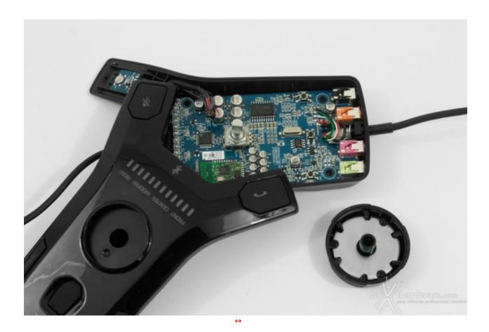
Il PCB interno al controller, codice EXD9802 V8.0, ospita un microcontrollore (MCU) Fujitsu Series MB95690K, un chip Bluetooth Broadcom BCM, un IC per il volume e vari componenti discreti.
