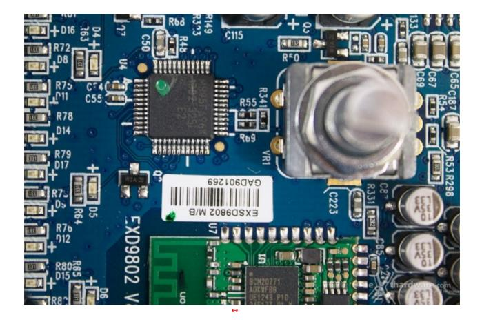
Nel dettaglio il Fujitsu MB95690K e, più in basso, il chip Broadcom BCM20771, un IC appositamente sviluppato per essere ospitato in headset stereo e comunicare con i dispositivi mobile compatibili tramite la tecnologia Bluetooth, restituendo una voce chiara e priva di incertezze.
