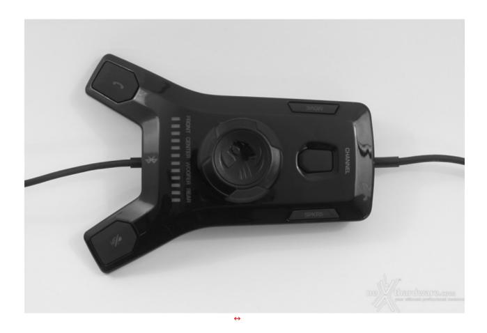
La grossa manopola centrale, oltre alla regolazione del volume tramite la rotazione, può essere premuta per disattivare contemporaneamente le uscite audio ed il microfono delle cuffie.
