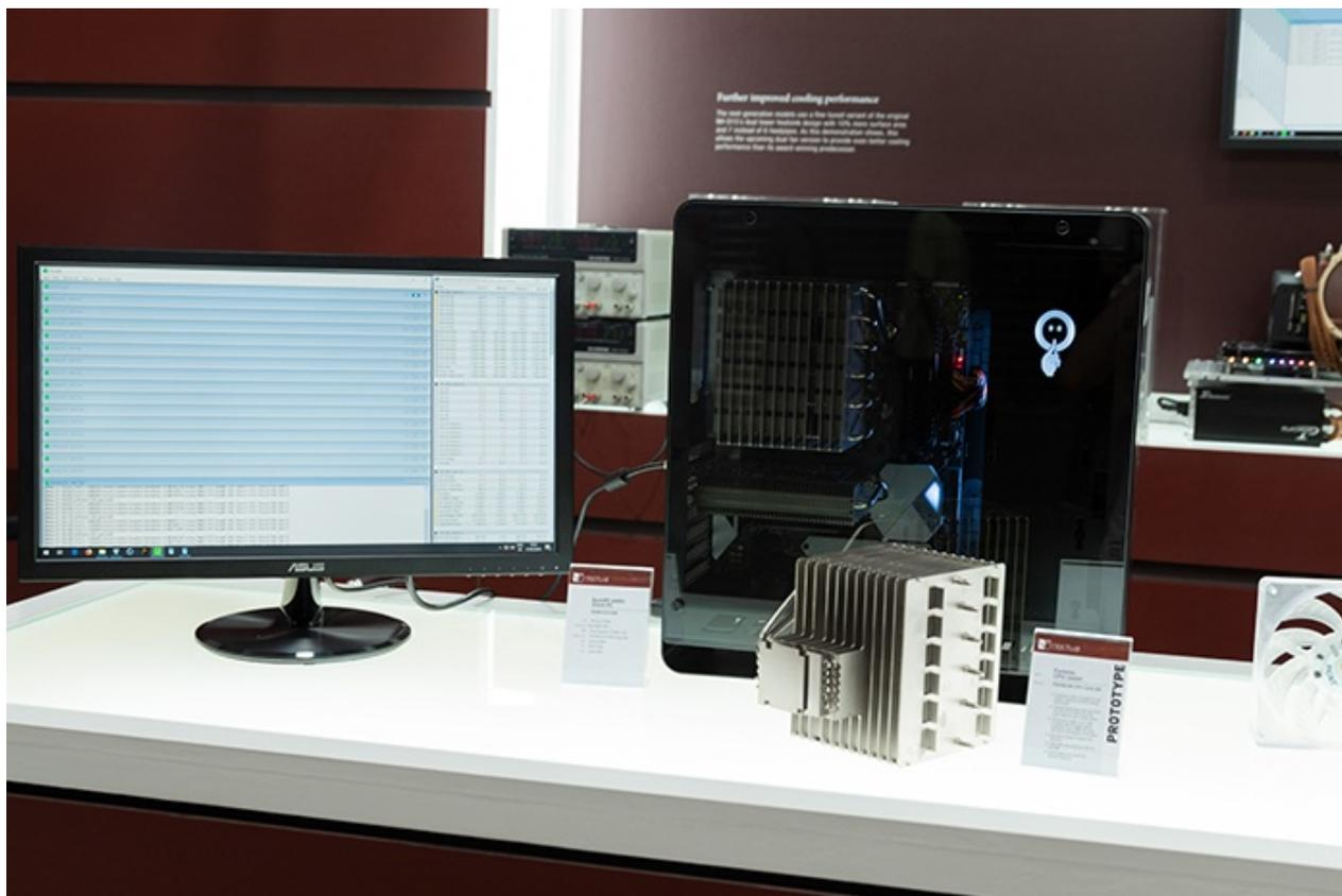
Non solo dissipatori attivi, ma anche modelli passivi nel futuro del produttore austriaco, che ha messo in mostra un mastodontico prototipo, dal peso di ben 1,5kg, capace di gestire le elevate temperature sprigionate da un i9 9900K durante una sessione di Prime95.
