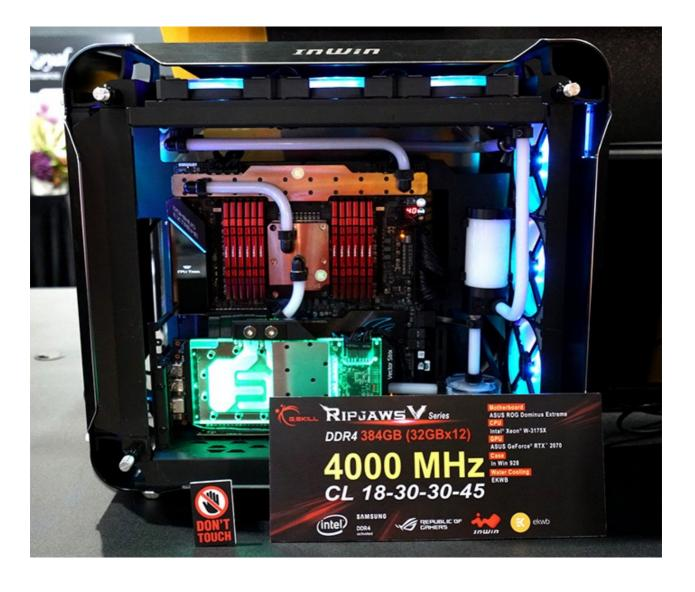
Grazie al supporto di ben sei canali di memoria, il processore Intel Xeon W-3175X è in grado di gestire i 12 moduli da 32GB ognuno del poderoso kit da 384GB di G.SKILL Ripjaws V, capace di operare ad una frequenza di 4GHz con timings pari a 18-30-30-45.
