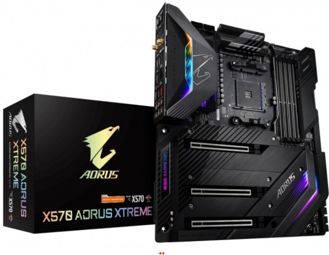
La top di gamma X570 AORUS XTREME, per esempio, è dotata di un sistema di alimentazione digitale Infineon con design a 16 fasi da 70A ognuna per garantire la massima stabilità operativa e di dissipatori di tipo Fins-Array con heatpipes a contatto diretto con i componenti interessati, oltre che un'armatura in metallo con trattamento in nanocarbonio, per un ottimale raffreddamento delle aree più critiche.
