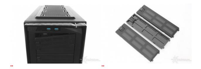
Sempre sulla parte anteriore, sono presenti tre bay per l'installazione di tre unità da 5,25", tutti protetti da un bezel in mesh metallica, facilmente removibile tramite un pratico sistema a sgancio rapido, basato su una piccola clip da azionare verso destra.
