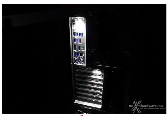
Anche il Source 530, al pari del Phantom, presenta un accattivante sistema di illuminazione a LED situato nella parte posteriore che, in alcuni casi, potrebbe rivelarsi discretamente utile qualora si dovessero collegare al volo delle periferiche aggiuntive in un ambiente scarsamente illuminato.
