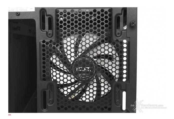
In alto a destra troviamo una generosa griglia, che lascia intravedere la ventola da 120mm in dotazione, sostituibile, all'occorrenza, con un modello da 140mm.
