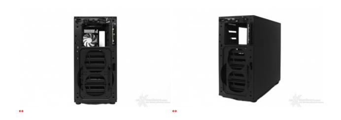
A questo punto, non solo potremo agire sulle ventole anteriori, assenti come dotazione standard, ma anche rimuovere il filtro dell'aria per eseguire le operazioni di pulizia.↔
