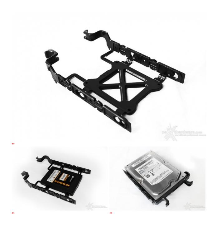
Il montaggio dei drive da 3,5" è completamente tool-less, ma per quelli da 2,5" sarà necessario usufruire delle viti in dotazione
