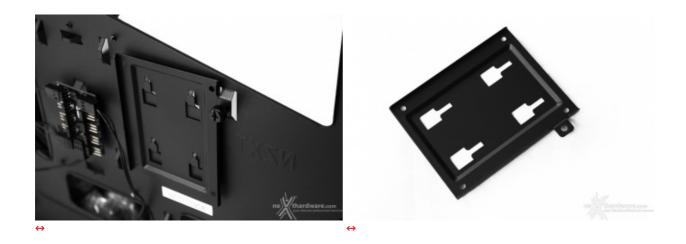
Sul retro del vassoio per la scheda madre è inoltre possibile installare un ulteriore drive da 2,5", utilizzando un apposito supporto.
