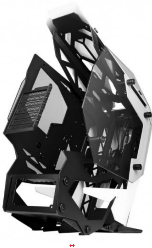
Per coloro che vorranno optare per un sistema di raffreddamento ad aria, sarà possibile utilizzare dissipatori con altezza massima di 215mm, mentre, per quanto concerne le schede video, non vi saranno restrizioni visti i 450mm a disposizione.
