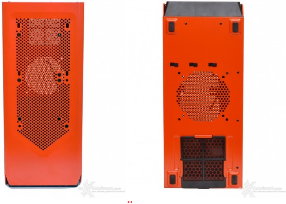
Sul top è possibile notare l'ampia griglia atta ad accogliere due ventole da 120/140mm, oppure un radiatore da 240mm.
