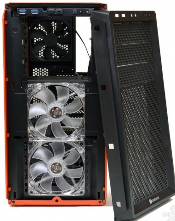
La rimozione del pannello, necessaria per la manutenzione o la sostituzione delle ventole, sarà facilitata dalle sei clip in plastica poste sui montanti laterali.
