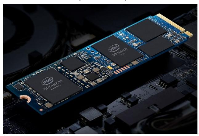
Intel ha rilasciato i primi dettagli su Optane H10, una soluzione che combina in un unico modulo M.2 la reattività tipica della tecnologia Intel Optane (3D XPoint) con la capacità di storage offerta dalle NAND 3D Quad Level Cell (QLC).
