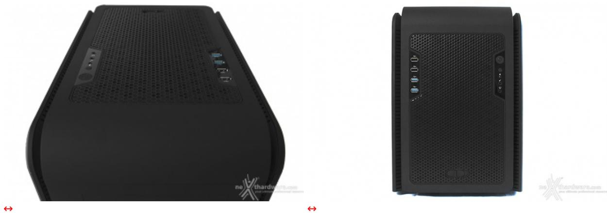
In posizione molto arretrata sono presenti due frame di plastica lucida, situati in posizione contrapposta, che ospitano, quello di sinistra, il pulsante d'accensione, quello di reset e i led di stato, mentre, quello di destra, due porte USB 2.0 e due USB 3.0.
