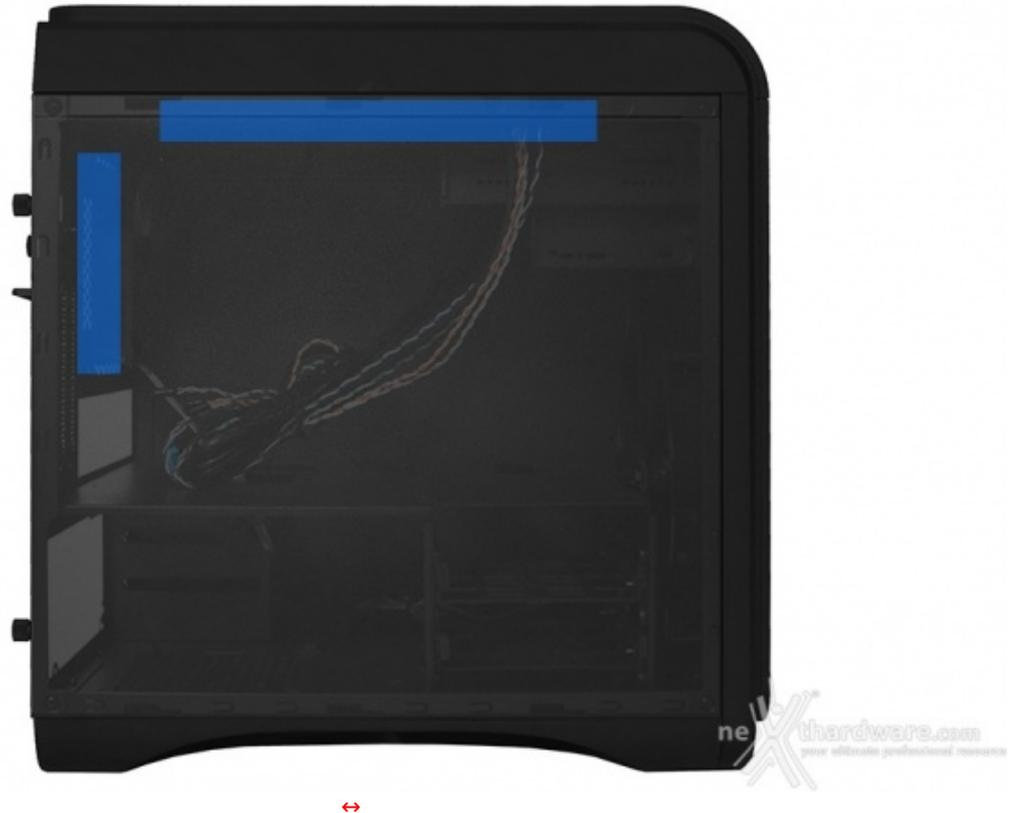
Inserendo un radiatore biventola nella parte alta del DS Cube, bisognerà fare i conti con impossibilità di installare periferiche da 5,25" nell'apposito vano, a meno che non si tratti di un Fan Controller od un lettore di memory card.
