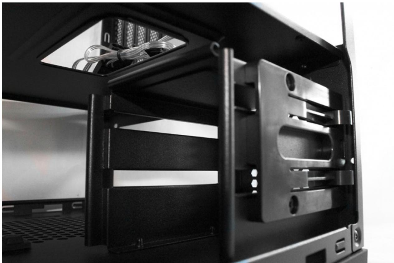
Alla base del case trovano spazio l'alimentatore e due cestelli separati per l'installazione dei drive.
