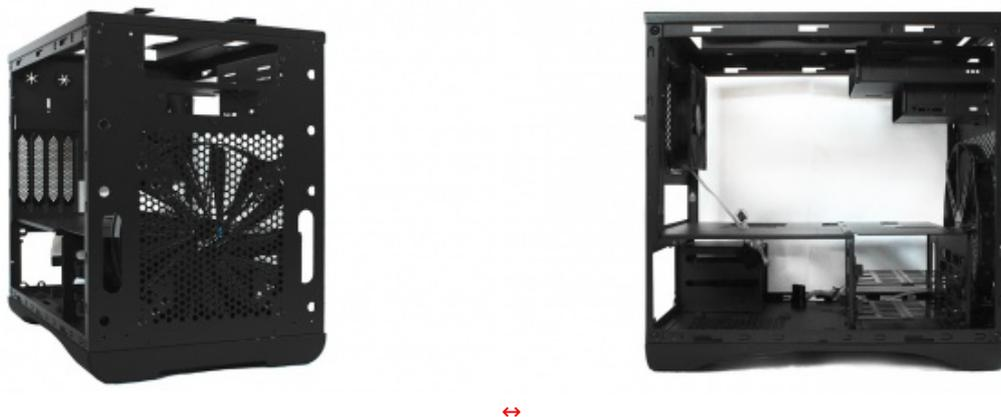
Nella parte alta del case è presente un alloggiamento per periferiche da 5,25" e, sotto di esso, trova spazio un cestello da 3,5" utilizzabile per un Fan Controller, un lettore di schede o per un hard disk.
