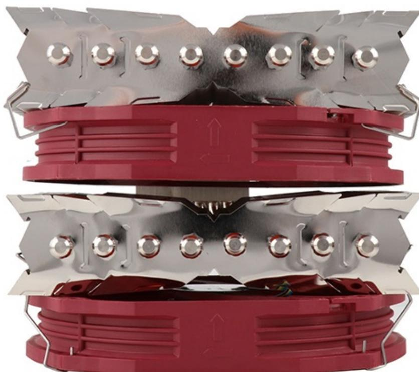
La struttura sostanzialmente rimane invariata e prevede due pacchi lamellari attraversati da otto heatpipes dal diametro di 6mm, raffreddati da due ventole TY-143 da 140mm con un regime di rotazione compreso tra i 600 ed i 2500RPM, un flusso di aria da 31,4 a 130CFM ed una rumorosità massima di 45
