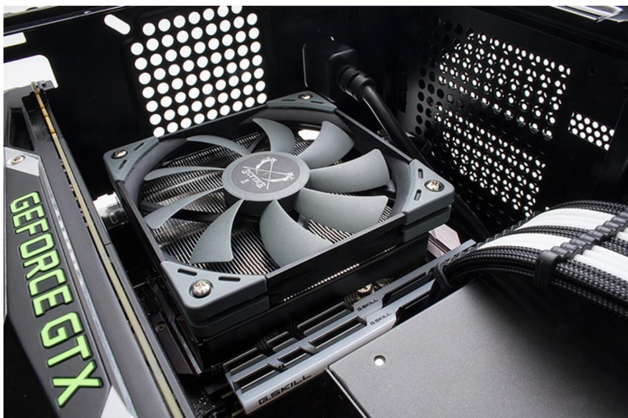
L'asimmetria della base rispetto al centro del dissipatore, ne consente l'utilizzo su qualsiasi scheda madre Mini-ITX, nonché la compatibilità con moduli RAM ad alto profilo.
