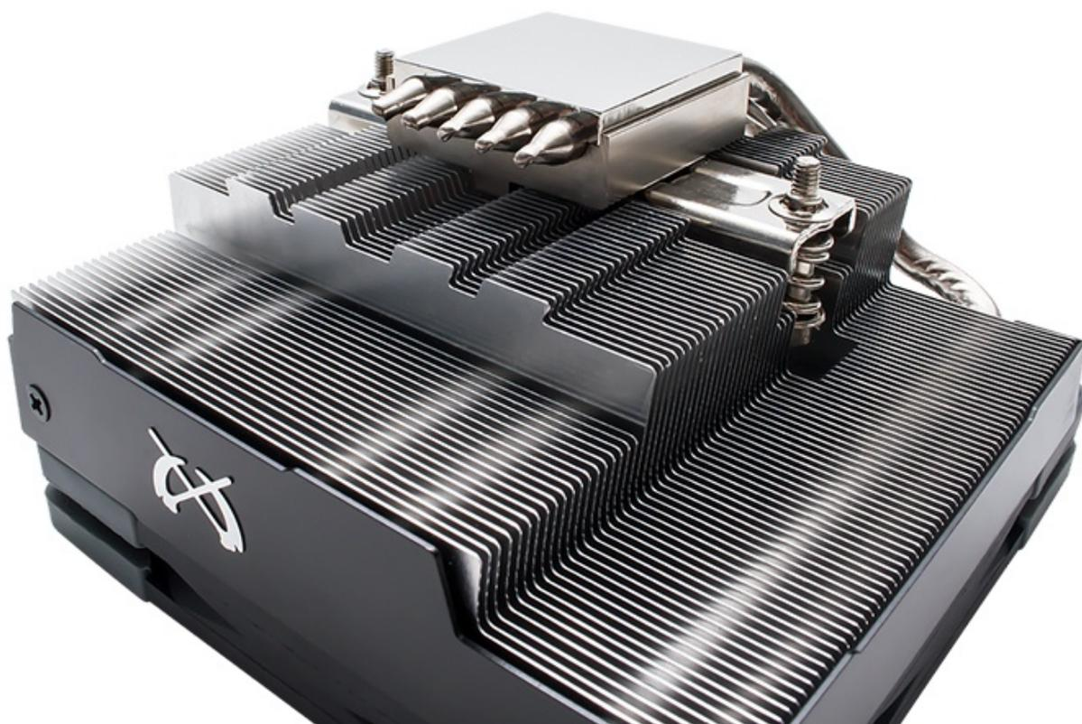
Il fitto corpo lamellare, collegato alla base tramite cinque heatpipe dal diametro di 6mm, garantisce un eccellente scambio termico ed una corretta dissipazione anche delle CPU con TDP elevato.
