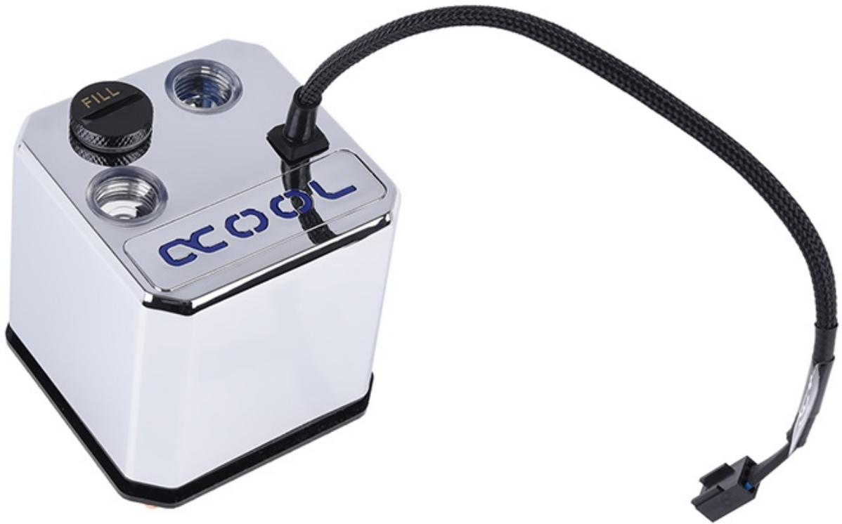
La pompa installata all'interno del monoblocco è dotata di cuscinetto in ceramica ed ha un regime di rotazione di 2.600 RPM con una portata di 70l/h ed una prevalenza pari a 0,84m, valori più che sufficienti per creare un loop dedicato al raffreddamento della sola CPU.
