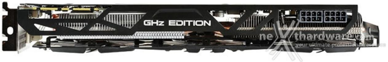
Per garantire un certo margine di Overclock e una notevole riserva di potenza, GIGABYTE ha deciso di includere due connettori di alimentazione PCI-E 8pin, in grado di gestire fino a 150W ciascuno che, abbinati ai 75W erogati dallo slot PCI-E x16, portano a 375W il massimo consumo teorico della scheda video.
