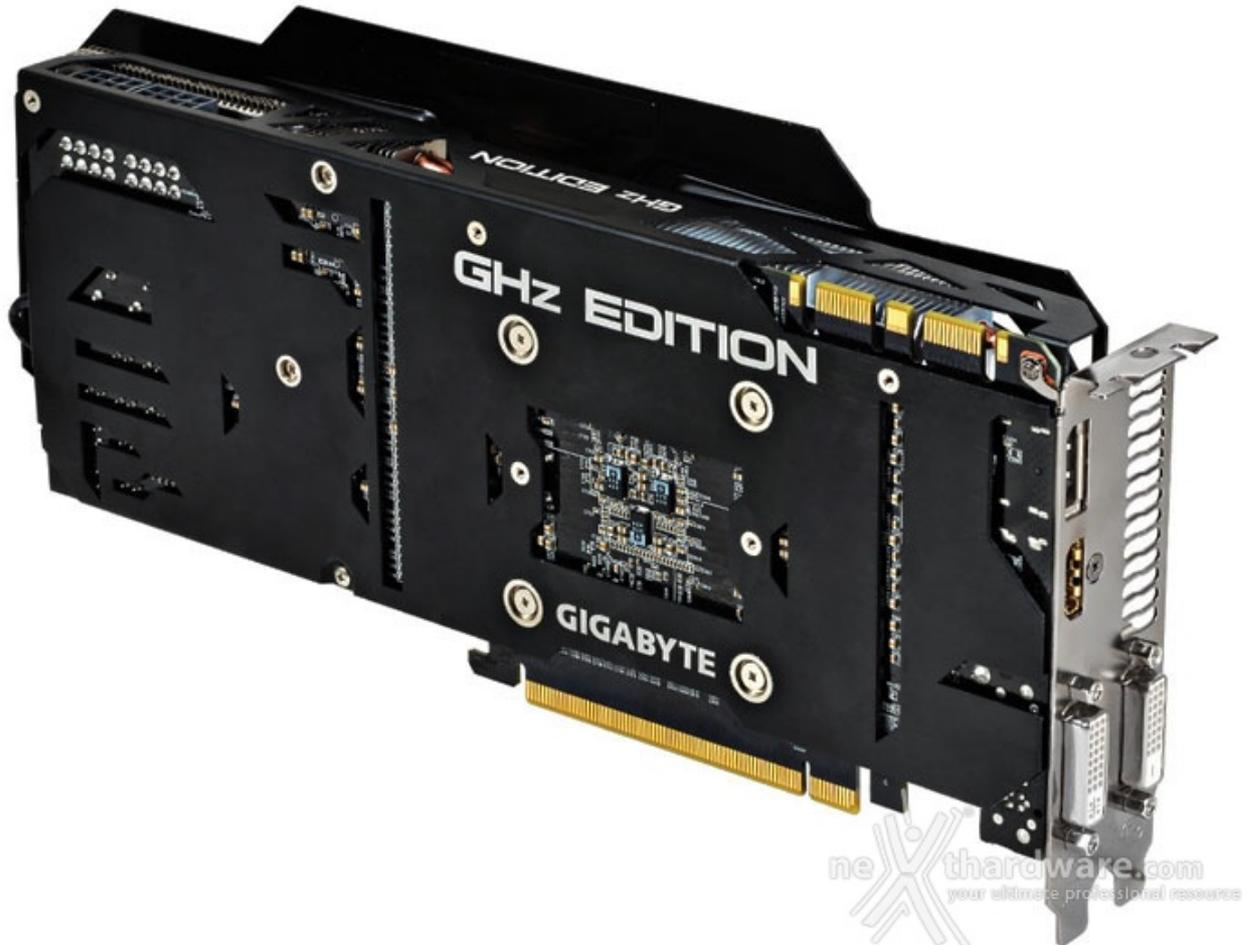
L'adozione dell'evoluto sistema di raffreddamento WINDFORCE 3X, garantisce buone temperature operative, così da permettere alla tecnologia NVIDIA GPU Boost di incrementare dinamicamente la frequenza della GPU a livelli anche maggiori rispetto a quelli dichiarati dal produttore.
