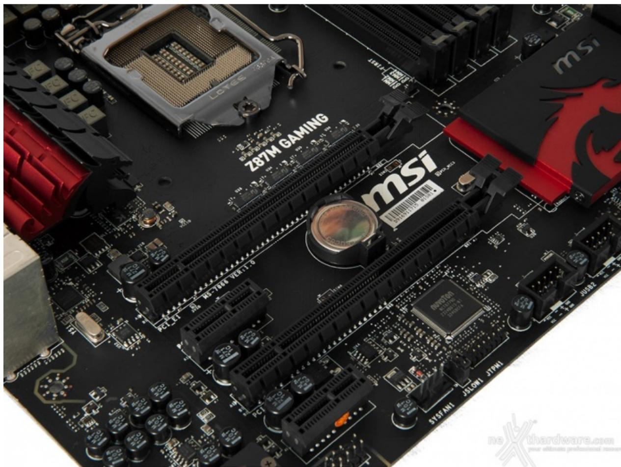
Nella foto in alto possiamo osservare la dotazione di slot PCIe della MSI Z87M Gaming, comprendente due slot PCI-E 16x 3.0 e due slot PCI-E 1x conformi allo standard 2.0.
