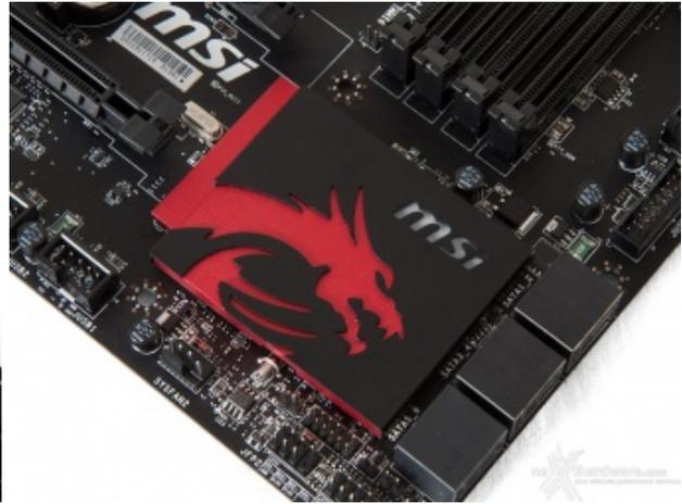
Il sistema di raffreddamento della MSI Z87M Gaming risulta suddiviso in due blocchi, di cui uno costituito da due dissipatori tradizionali di generose dimensioni, e l'altro da un elemento a basso profilo privo di alette, tutti realizzati in alluminio di colore nero e rosso.
