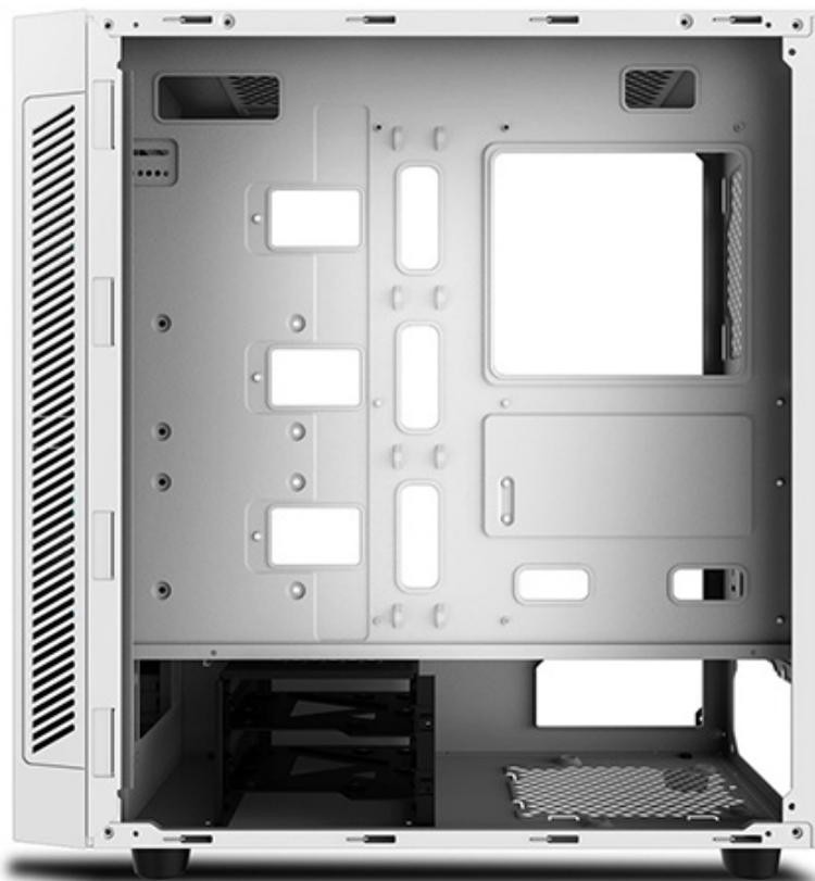
Frontalmente possono essere fissate tre ventole da 120 o 140mm, sul top due da 120 o 140mm e, sul retro una da 120mm; tutte le predisposizioni, inoltre, possono essere utilizzate anche per installare radiatori facenti parte di sistemi di raffreddamento a liquido custom.
