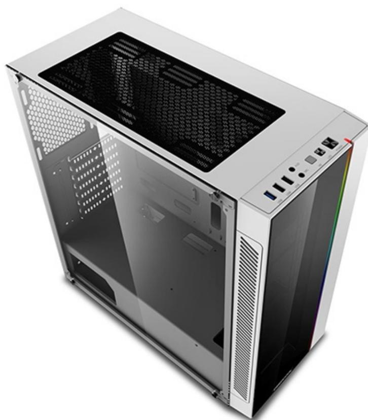
Con dimensioni pari a 440x210x480mm (PxLxA) per un peso di circa 7kg, il MATREXX 55 ADD-RGB Silver è un mid tower in grado di contenere una scheda madre in formato E-ATX o inferiore, schede video lunghe sino a 370mm, due drive da 2,5" o 3,5" più altri due da 2,5", dissipatori ad aria alti 168mm.
