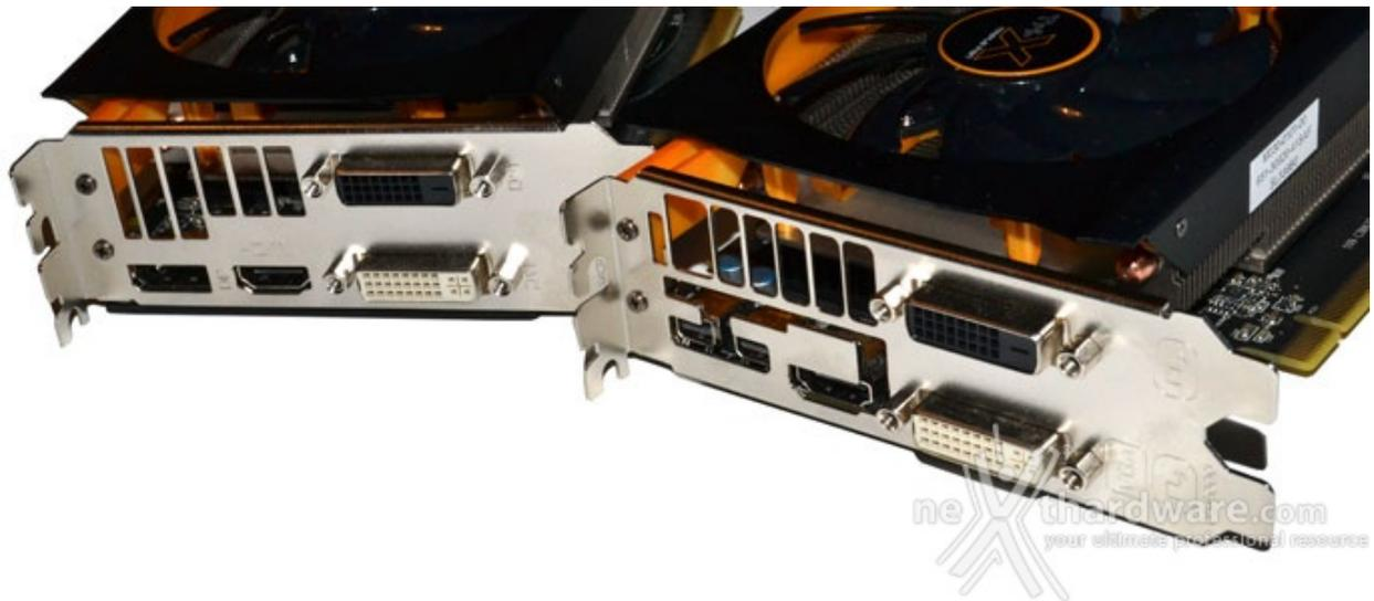
La R9 280X TOXIC è equipaggiata con una uscita DVI-I-DL, una DVI-D-SL, una HDMI High Speed e due mini DisplayPort 1.2.
