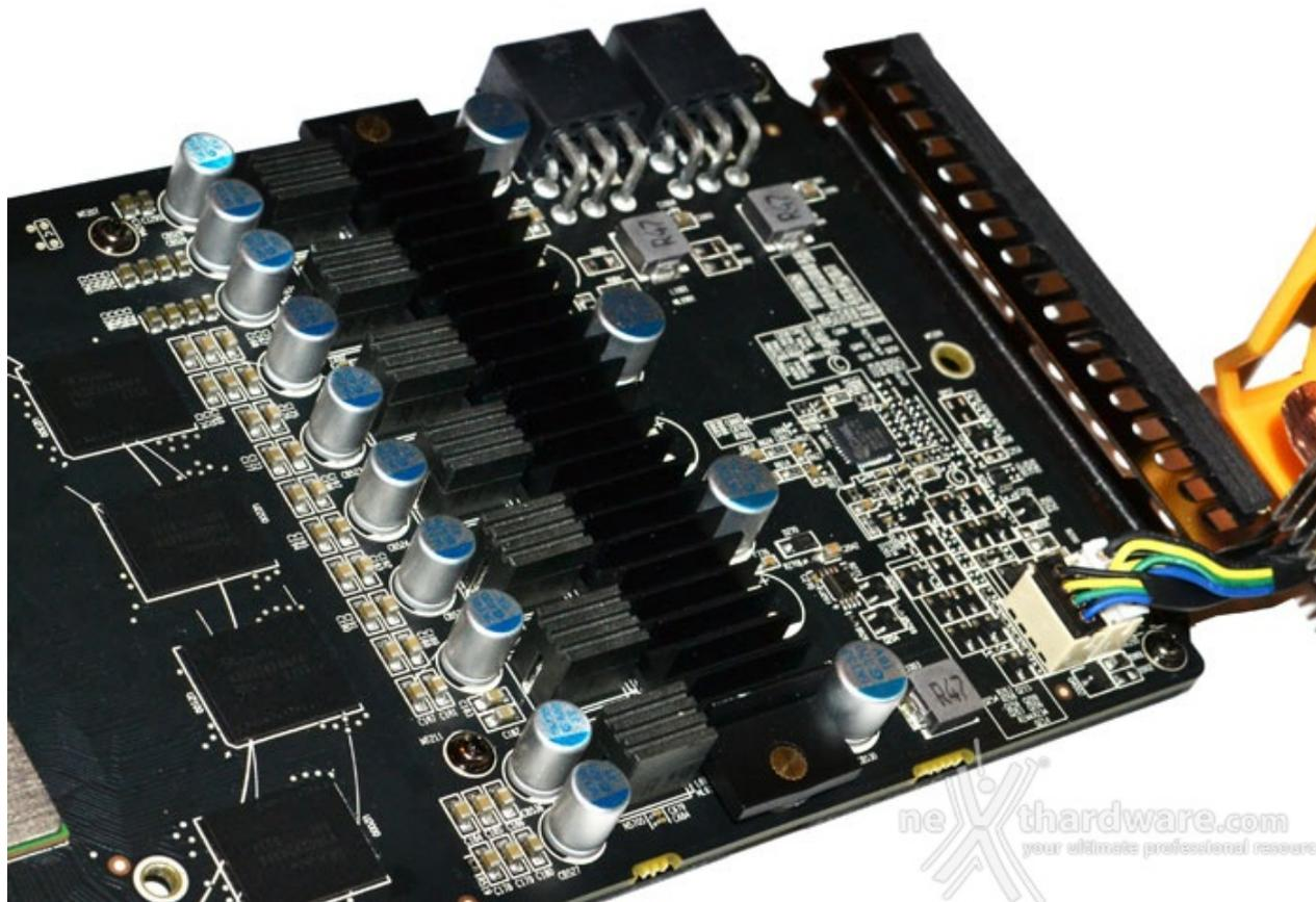
Sette sono le fasi di alimentazione per la GPU e una per le memorie, mentre due sono i connettori PCI-E 6pin necessari per poter fornire l'energia necessaria alla scheda (75W ciascuno).
