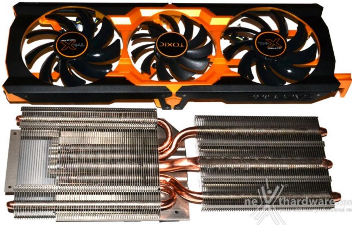
Il sistema di raffreddamento è composto da una Vapor Chamber posta a diretto contatto con la GPU e da ben cinque heatpipes che distribuiscono il calore su tutta la superficie radiante.
