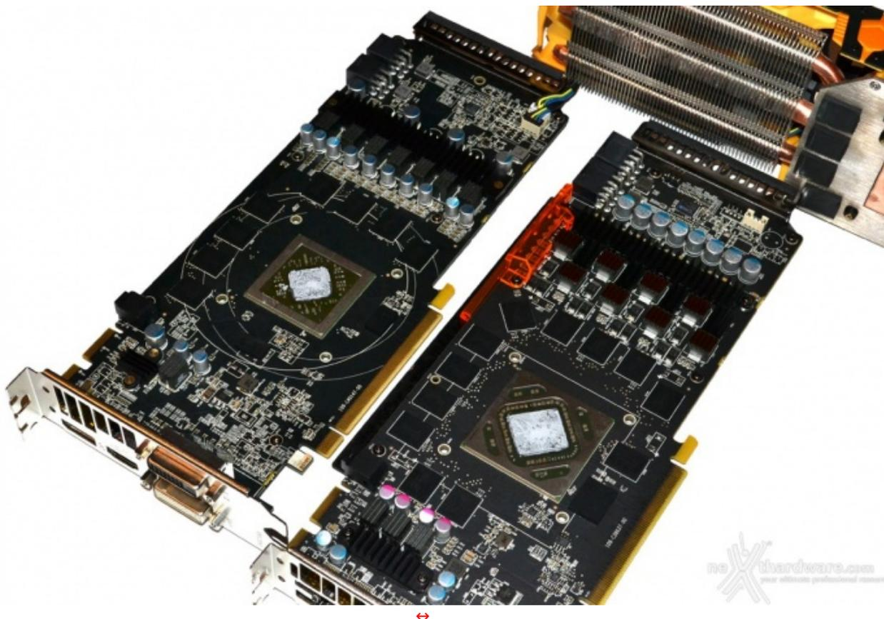
Rimosso il dissipatore è subito evidente come le due schede siano profondamente diverse tra loro, sia nella GPU e nella memorie video, che nella complessità della sezione di alimentazione.
