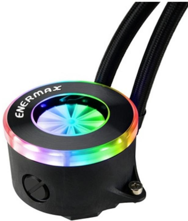
Come i modelli più piccoli, il nuovo All-in-One salta subito all'occhio per il waterblock, dotato di un coperchio in acrilico che permette di vedere un indicatore di flusso ed un sistema di illuminazione ARGB in grado di sincronizzarsi sia con le schede madri di ultima generazione che con le tre ventole T.B. RGB da 120mm presenti in dotazione.
