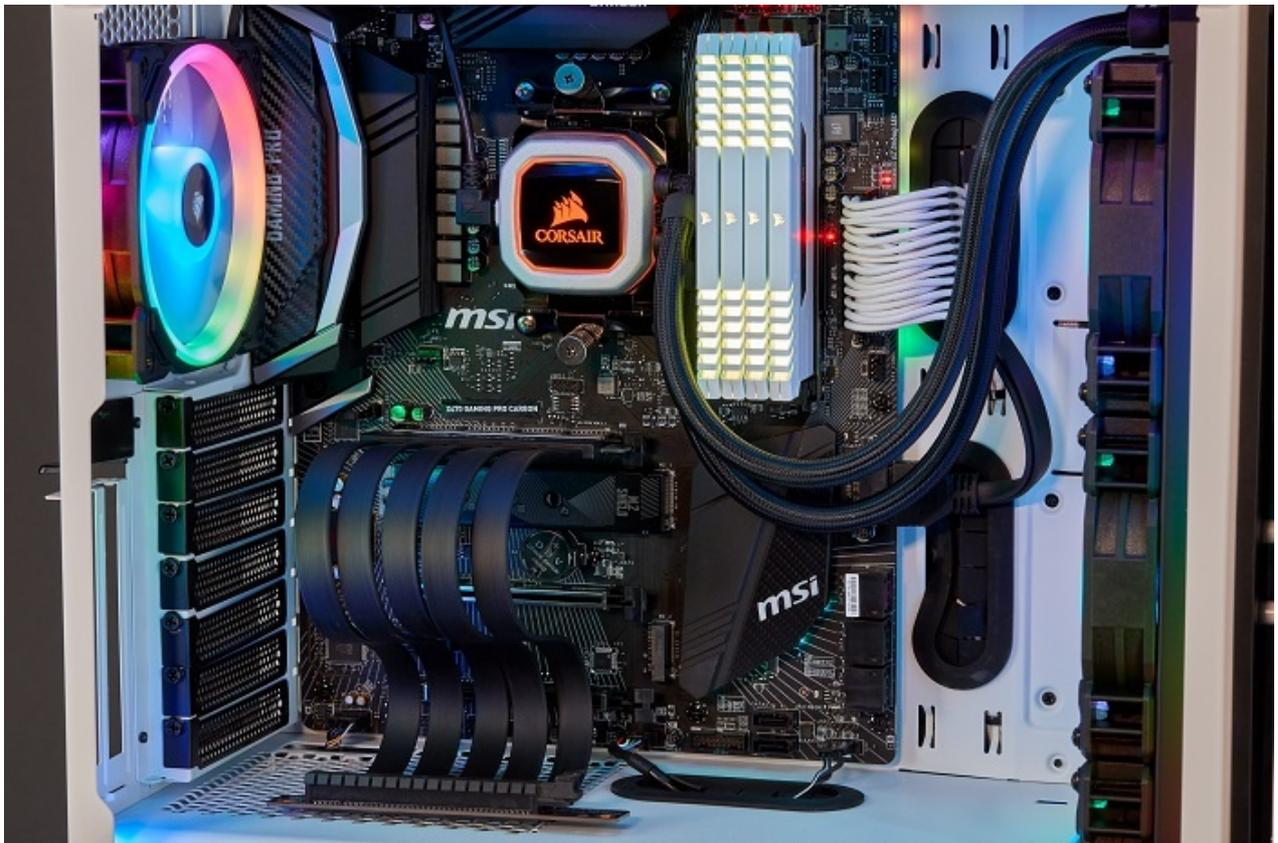
Ulteriore novità è costituita dal PCIe 3.0 x16 Extension Cable, una generosa soluzione da 300mm per le configurazioni con scheda grafica verticale come, ad esempio, sul CORSAIR Obsidian 500D.
