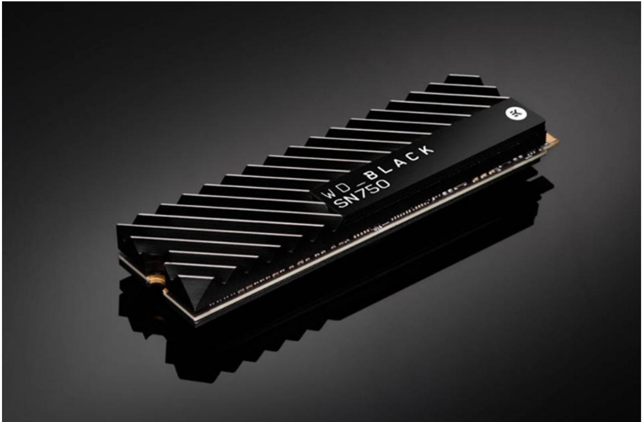
Realizzati con fattore di forma M.2 2280 e dotati di interfaccia PCI Express 3.0 x4 con supporto per il protocollo NVMe 1.3, i nuovi WD Black SN750 adottano un controller sviluppato in-house e memoria 3D NAND TLC 3D a 64 strati di produzione SanDisk, coadiuvati da 1GB di cache DRAM DDR4 SK Hynix.
