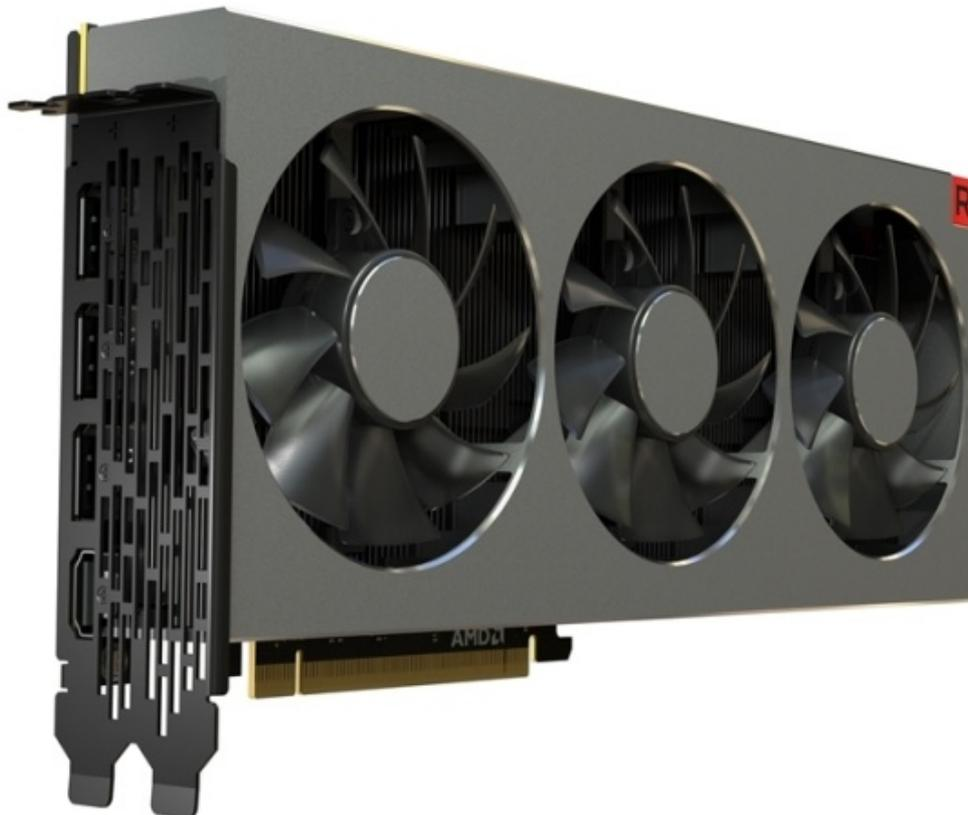
Ricapitoliamo ... Radeon Vega VII vanta un'architettura che è una versione vitaminizzata di quella presente su Vega 64, con prestazioni superiori mediamente di circa il 25% a fronte di un TDP rimasto invariato, ovvero 300W.
