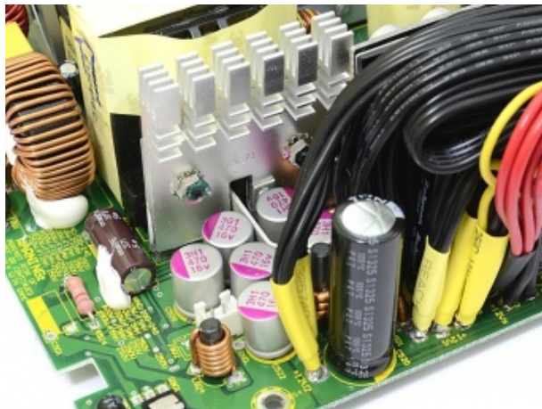
Particolare dei condensatori di filtraggio finale e del dissipatore privo di componenti dello stadio secondario.
