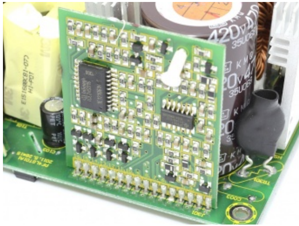
Particolare della daughter-card con il controller dei transistor di switching e del PFC.
