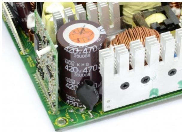
Condensatore primario Nippon Chemi-con
