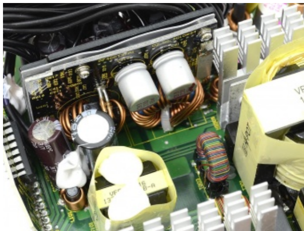
Particolare del modulo DC-DC per la generazione delle tensioni da 5 e 3,3 Volt.
