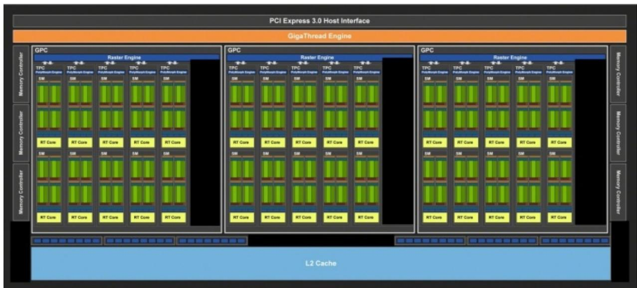
Guardando alle specifiche, troviamo sempre una GPU TU106 come per la sorella maggiore RTX 2070 ma, ovviamente, in versione ridotta: 1920 CUDA Cores, 240 Tensor Cores, 30 RT Cores, 120 TMUs e 48 ROPs.
