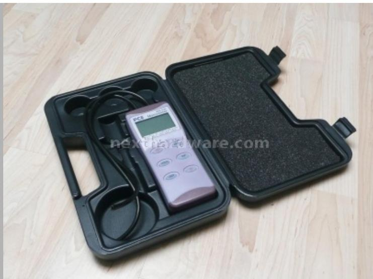
Per saggiare le prestazioni delle due cover abbiamo rilevato il valore della pressione generata dalla pompa in funzione della portata così da poter estrapolare il grafico che mette in relazione le due grandezze.
