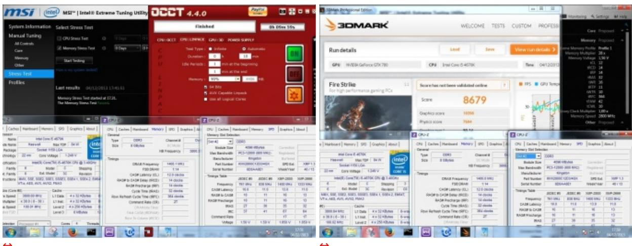
Test di stabilità a 2800MHz 12-14-14-32 2T @ 1,56V
