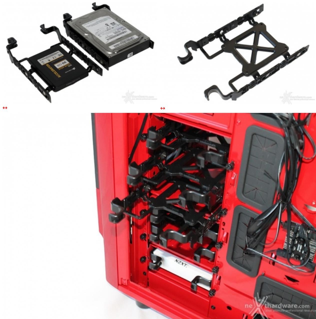
Una volta posizionato il drive sul proprio supporto, basterà inserirlo rimuovendo la paratia destra del case.
