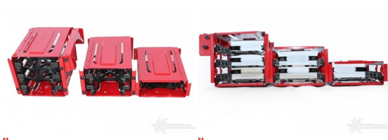
I tre cestelli sono fermati al vassoio della mainboard tramite viti thumbscrew presenti sulla parte destra del case e possono ospitare, rispettivamente, tre, due ed un unico drive.
