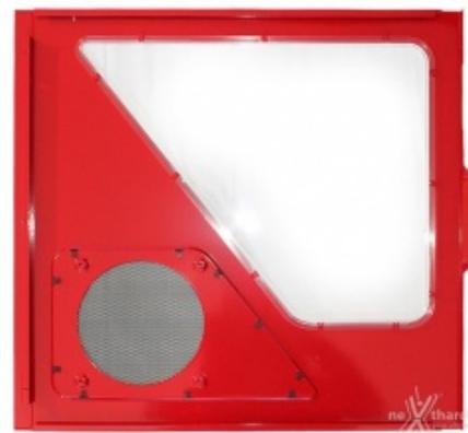
I pannelli laterali sono realizzati in lamiera di discreto spessore e sono verniciati da entrambi i lati.
