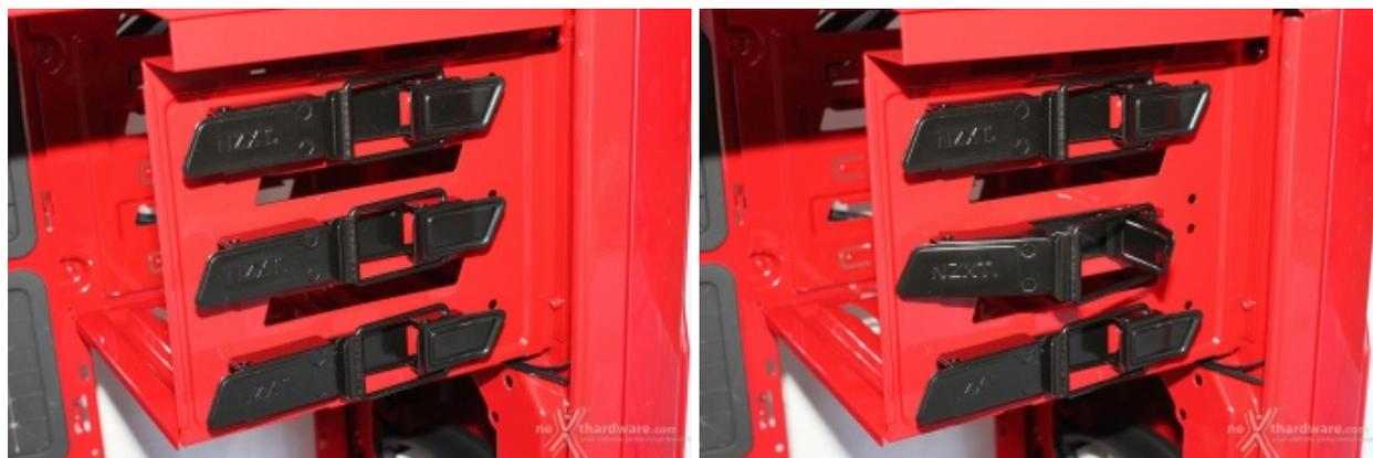
Le periferiche da 5,25" possono essere montate senza l'ausilio di strumenti.
