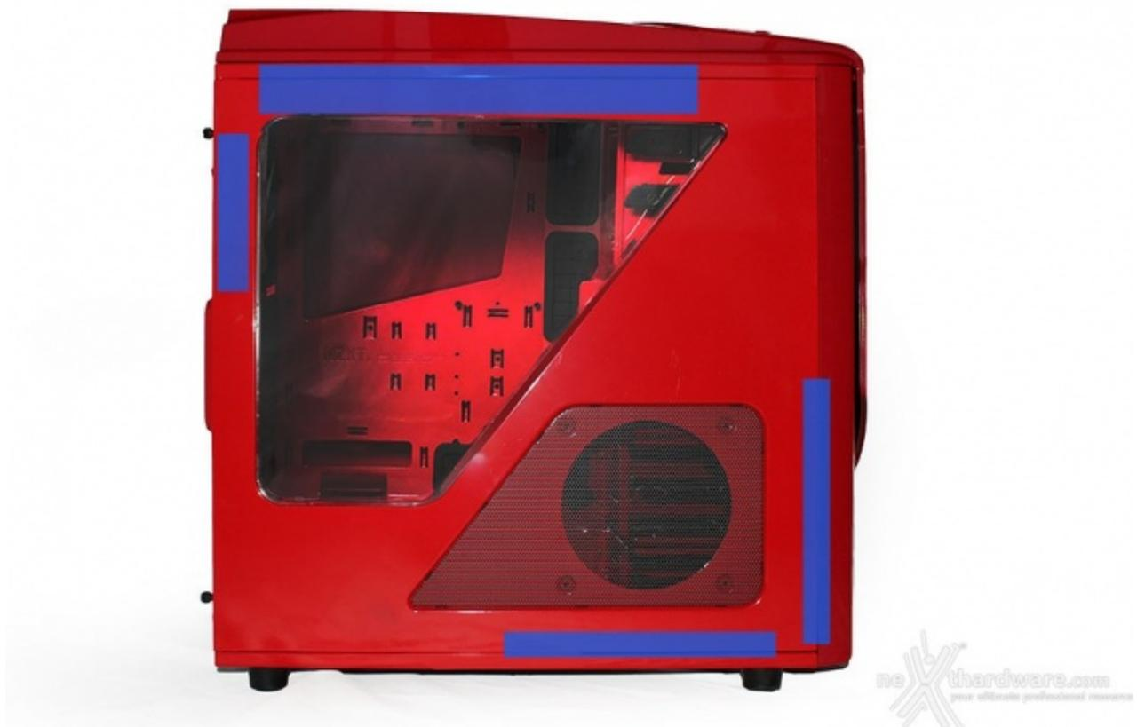
Posteriormente, utilizzando il supporto per ventola da 120/140mm, è possibile installare un radiatore monoventola mentre frontalmente, rinunciando agli alloggiamenti per drive, è possibile montare addirittura un biventola.
