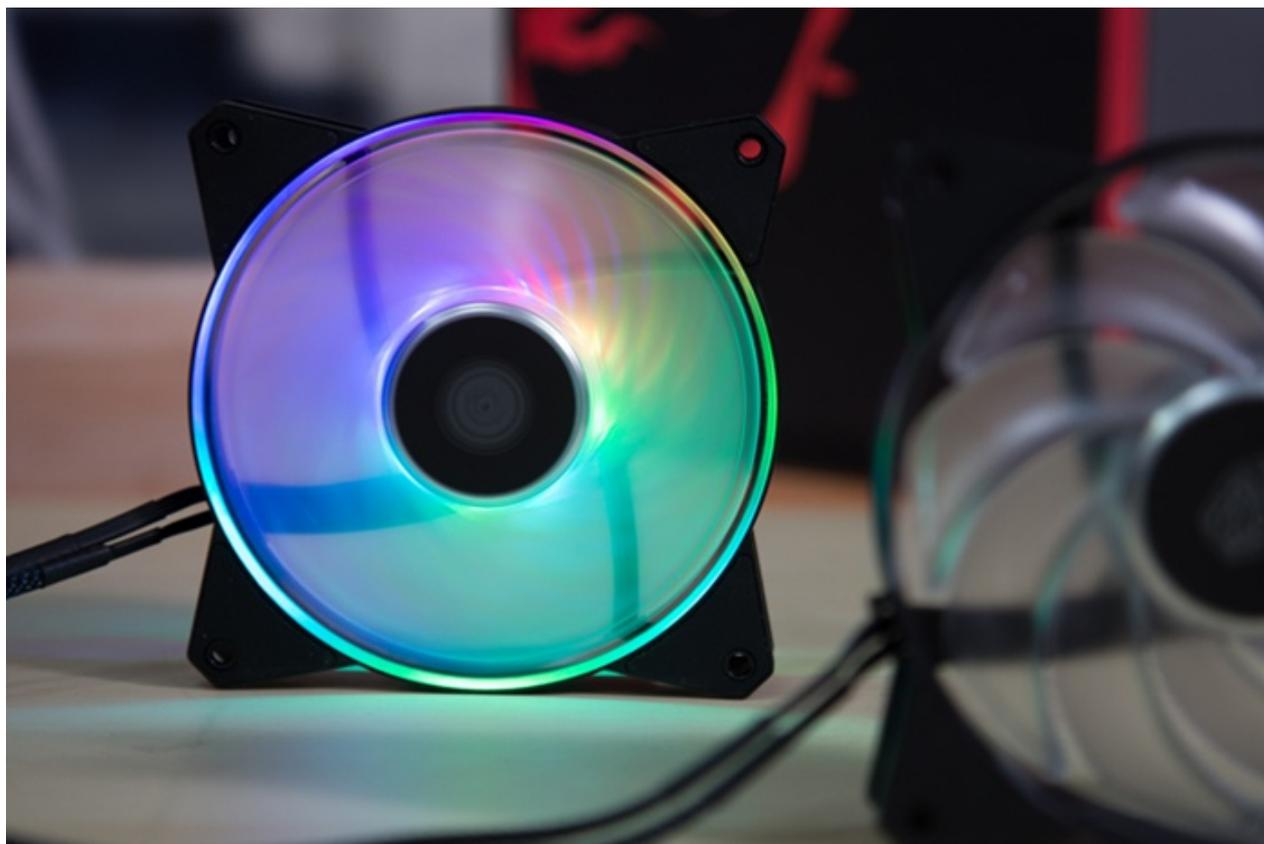
Ogni ventola è dotata di otto LED controllabili sia tramite il software MasterPlus+ che tramite l'addressable RGB LED small controller, venduto separatamente, dotato di specifici pulsanti che permetteranno diverse modalità ed effetti.
