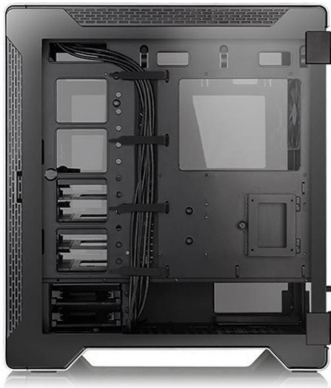
Come di consueto, Thermaltake ha usato particolare attenzione anche sotto il punto di vista termico, dando all'utente la possibilità di montare tre ventole da 120 o 140mm lungo il frontale, dove ne sono già presenti due da 120mm, una da 120mm sul retro (anche questa in dotazione) e tre da 120mm o due da
