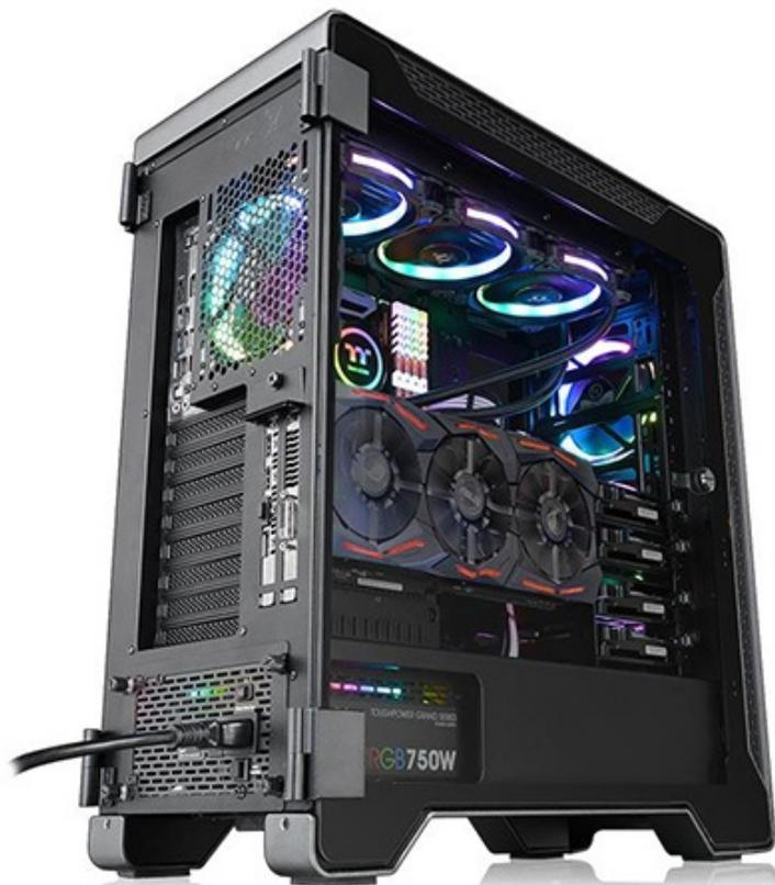
Tutte le predisposizioni sono utilizzabili anche per il posizionamento di radiatori facenti parte di sistemi di un raffreddamento a liquido custom che, visto lo spazio interno, potrà essere facilmente installato.
