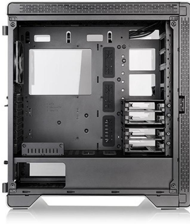
All'interno, oltre ad una scheda madre in formato ATX, possono trovar spazio schede video lunghe 295mm o 420mm (in assenza dei cestelli), sei drive da 3,5" o 2,5" più uno da 2,5" sul retro del piatto mainboard ed un dissipatore ad aria per CPU alto 160mm.
