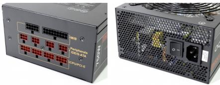
I connettori per il cablaggio modulare, suddivisi in gruppi, sono facilmente distinguibili sia per forma che colore, sia per le indicazioni riportate mediante serigrafia.
