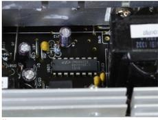
Controller combo transistor di switching e PFC
