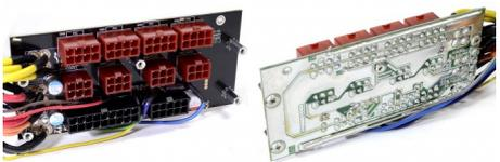
Il pannello delle connessioni modulari ospita tre condensatori elettrolitici ed alcuni collegamenti esterni a sostegno delle generose piste osservabili sul retro.
