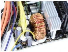
Particolare della sezione di filtraggio della tensione principale.
