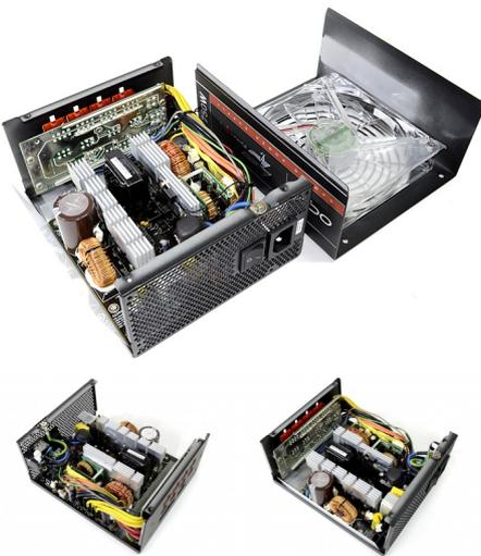
Rimosse le quattro viti che trattengono la cover superiore, possiamo separare le due parti dello chassis, così da iniziare l'osservazione della componentistica interna.
