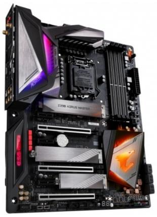
La presenza di un doppio connettore EPS 8+8 pin con tecnologia Solid Pin, che prevede l'utilizzo di elementi interamente in metallo in luogo di quelli vuoti all'interno, sia per i due connettori sopracitati che per quello ATX 24 pin, garantisce che la sezione di alimentazione riceva tutta l'energia necessaria, in particolar modo nelle condizioni di carico più gravose.
