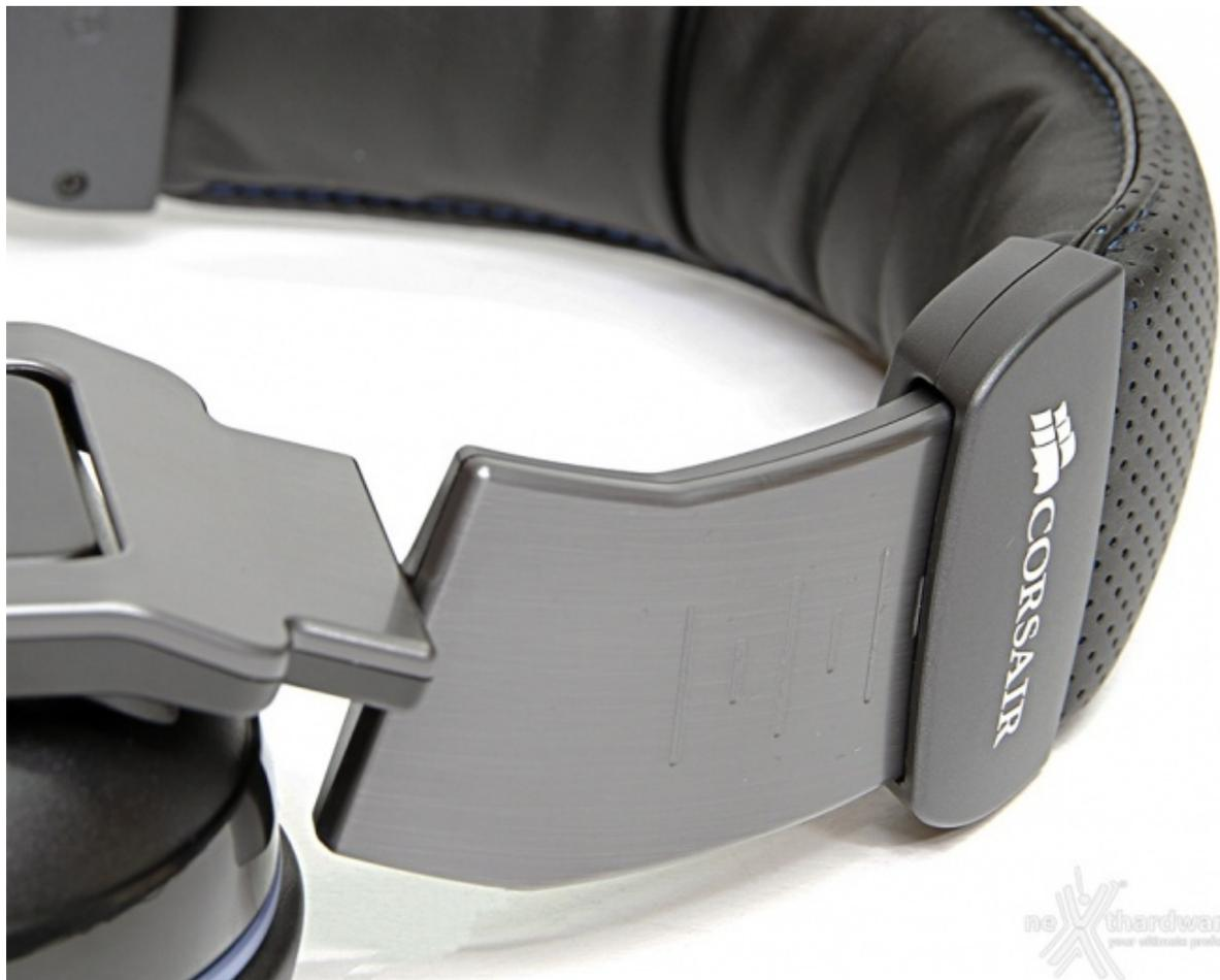
La regolazione è affidata anche in questo modello ad una clip in plastica che si bloccherà automaticamente, grazie a delle linee incavate nei lati.
