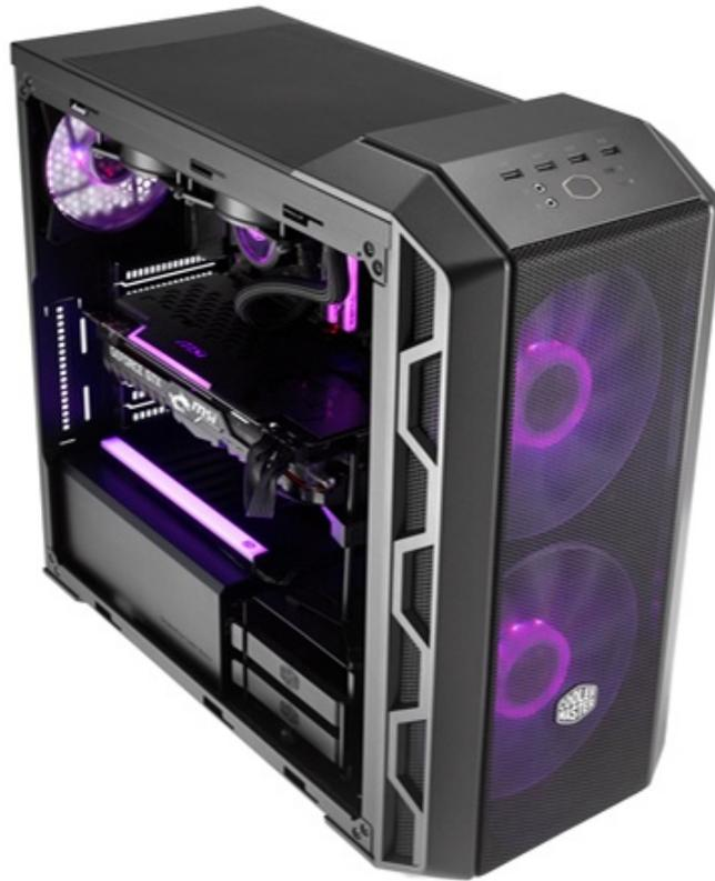
Come da tradizione, nonostante si tratti della versione "base", il MasterCase H500 offre svariate soluzioni per ventole e radiatori: nella parte frontale possono essere posizionate tre ventole da 120mm, due da 140 o due da 200 mm (incluse), sul top due da 120 o 140mm oppure una da 200mm, mentre per il pannello posteriore troviamo la predisposizione per una singola ventola da 120mm (inclusa).
