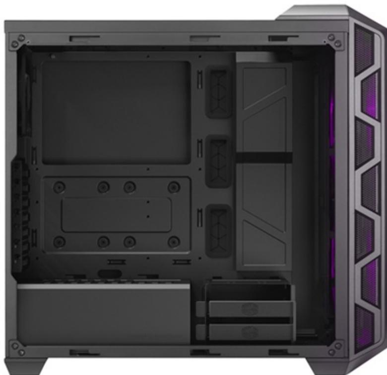
Nel nuovo case è possibile montare schede madri in formato ATX o inferiore, schede video lunghe fino a 410mm, alimentatori da 180mm e due drive da 3,5" o 2,5" più altri due da 2,5" sul retro del piatto mainboard.
